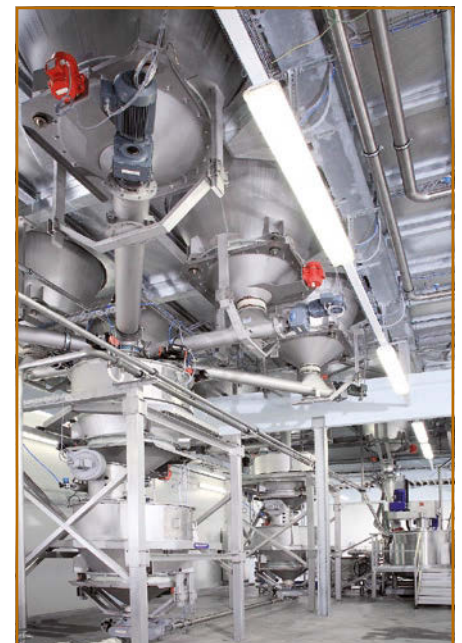
Abb. 1: Exakte Dosierung der Chargenkomponenten durch Dosierschnecken in die Behälterwaagen und pneumatische Zuführung in den Dissolver-Mischer.
