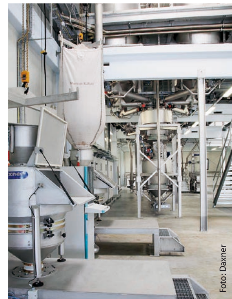
Aufgabestation für die Produktaufgabe von Sackware und Big Bag sowie die pneumatische Förderung in den zugehörigen Tagessilo.
