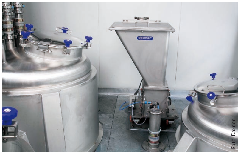
Gravimetrische Dosierung der Kleinstkomponenten mittels Dosierapparat DA 060
