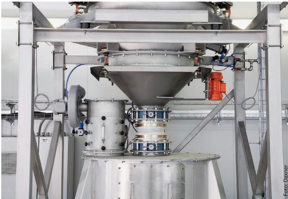
Behälterwaage mit Vibroausgabeboden, Waagenachbehälter und Schleusenleckluft-Abführung mittels Düsenfilter DFK.
