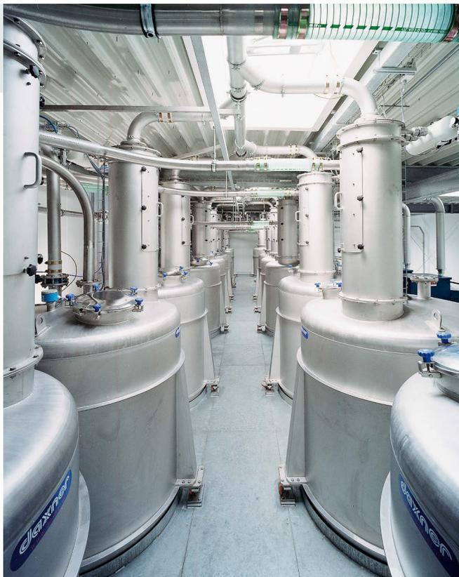
◀ Tagesbehälter zur Vorlage von Komponenten wie Milchpulver, Kakao-pulver, Zucker etc. werden pneumatisch, unter Verwendung von ge-kühlter und getrockneter Förderluft beschickt
