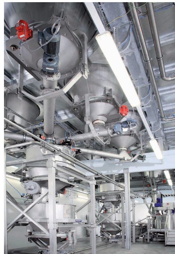
Exakte Dosierung der Chargenkomponenten durch Dosierschnecken in die Behälterwaagen und pneumatische Zuführung in den Dissolver-Mischer
