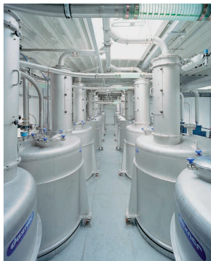
Tagesbehälter zur Vorlage von Komponenten wie Milchpulver, Kakaopulver, Zucker etc. werden pneumatisch, unter Verwendung von gekühlter und getrockneter Förderluft beschickt
