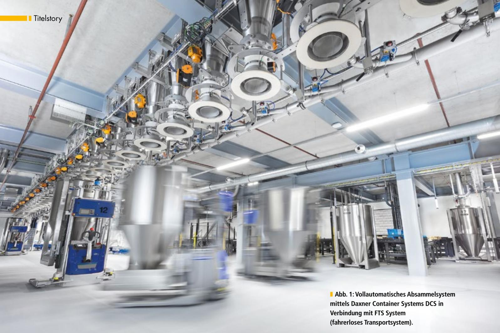
■ Abb. 1: Vollautomatisches Absammelsystem mittels Daxner Container Systems DCS in Verbindung mit FTS System (fahrerloses Transportsystem).
