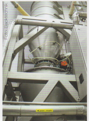
Bild links: Das 30 Tonnen Zuckersilo und die drei 50 Tonnen Mehlsilos befinden sich im Außenbereich der Bäckerei. Das Mehl für die Produktion liefert die zum Konzern gehörige Mühle. Bild Mitte: Sowohl die Kleinkomponenten als auch Mehl und Zucker müssen vor der Verarbeitung gesiebt werden, um Verunreinigungen auszuschließen. Bild rechts: Während in der unteren Waage das Mehl der kontinuierlichen Vermischung zugeführt wird, kann in der oberen Waage das nächste Batch abgewogen werden.
