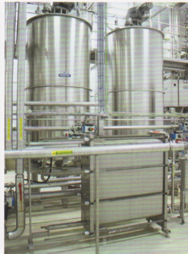
Bild links: In zwei Reifebehältern hat der Vorteig Zeit sich zu entwickeln. Links im Bild der große, gekühlte Lagertank. Bild Mitte: Bevor der Vorteig in den Lagertank fließt, wird er im Plattenwärmetauscher auf fünf Grad Celsius heruntergekühlt. Bild rechts: Ein umfangreiches Kühlsystem sorgt dafür, dass die einzelnen Komponenten die gewünschte Temperatur aufweisen.
