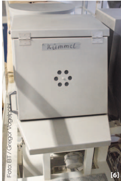
[5] Die großen Außensilos mit Vibrationsboden sind über das Rohrsystem mit beiden Verwiegeinheiten verbunden. [6] Im Frankenland ist Kümmel eine viel verwendete Zutat – nicht nur bei der Brotherstellung – und wird daher über die Kleinkomponentenanlage verwogen.
