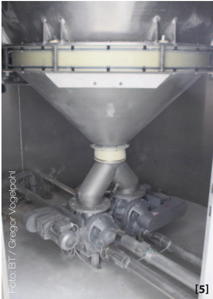
[5] Die großen Außensilos mit Vibrationsboden sind über das Rohrsystem mit beiden Verwiegeinheiten verbunden. [6] Im Frankenland ist Kümmel eine viel verwendete Zutat – nicht nur bei der Brotherstellung – und wird daher über die Kleinkomponentenanlage verwogen.
