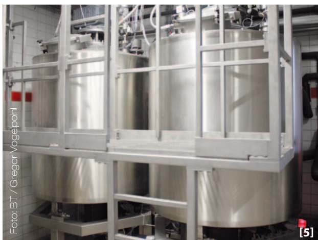
[5] In den beiden Tanks lagern Flüssighefe (rechts) und die fertige Crememasse aus Restbrot und Wasser. [6] Restteig aus der Produktion wird zunächst mit Wasser vermischt und dann dem Anteiger zugegeben. [7] Durch die circa minus sieben Grad Celsius kalte Salzsole kann bei vielen Teigen auf die Zugabe von Scherbeneis verzichtet werden.
