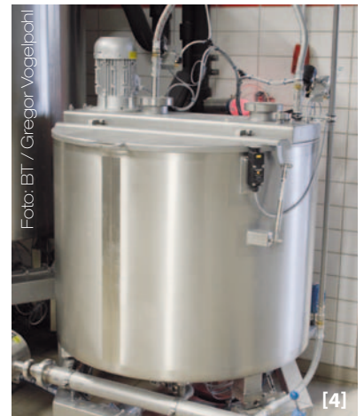
[2] Der Anteiger Dax Dou ist nach dem Prinzip eines Durchlaufmischers konzipiert und besitzt für die Teigerstellung speziell, konstruierte Knetwerkzeuge. [3] Für die Verwiegung der Kleinkomponenten sind jeweils acht Silos vorgesehen. Die Zutaten fallen nach der Dosierung durch ein Rohr direkt in die Kneterschale. [4] Nach einer kurzen Rührphase, die unter zehn Minuten liegt, ist die Flüssighefe gebrauchsfertig und kann in den daneben stehenden Lagertank umgepumpt werden.
