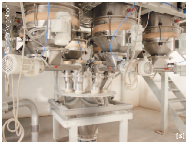
[2] Der Anteiger Dax Dou ist nach dem Prinzip eines Durchlaufmischers konzipiert und besitzt für die Teigerstellung speziell, konstruierte Knetwerkzeuge. [3] Für die Verwiegung der Kleinkomponenten sind jeweils acht Silos vorgesehen. Die Zutaten fallen nach der Dosierung durch ein Rohr direkt in die Kneterschale. [4] Nach einer kurzen Rührphase, die unter zehn Minuten liegt, ist die Flüssighefe gebrauchsfertig und kann in den daneben stehenden Lagertank umgepumpt werden.
