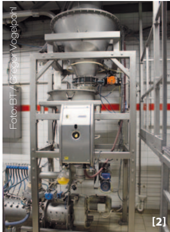
[2] Der Anteiger Dax Dou ist nach dem Prinzip eines Durchlaufmischers konzipiert und besitzt für die Teigherstellung speziell konstruierte Knetwerkzeuge. [3] Für die Verwiegung der Kleinkomponenten sind jeweils acht Silos vorgesehen. Die Zutaten fallen nach der Dosierung durch ein Rohr direkt in die Kneterschale. [4] Nach einer kurzen Rührphase, die unter zehn Minuten liegt, ist die Flüssighefe gebrauchsfertig und kann in den daneben stehenden Lagertank umgepumpt werden.
