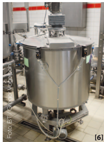
[5] In den beiden Tanks lagern Flüssighefe (rechts) und die fertige Crememasse aus Restbrot und Wasser. [6] Restteig aus der Produktion wird zunächst mit Wasser vermischt und dann dem Anteiger zugegeben. [7] Durch die circa minus sieben Grad Celsius kalte Salzsole kann bei vielen Teigen auf die Zugabe von Scherbeneis verzichtet werden.
