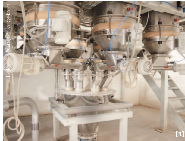
[2] Der Anteiger Dax Dou ist nach dem Prinzip eines Durchlaufmischers konzipiert und besitzt für die Teigherstellung speziell konstruierte Knetwerkzeuge. [3] Für die Verwiegung der Kleinkomponenten sind jeweils acht Silos vorgesehen. Die Zutaten fallen nach der Dosierung durch ein Rohr direkt in die Kneterschale. [4] Nach einer kurzen Rührphase, die unter zehn Minuten liegt, ist die Flüssighefe gebrauchsfertig und kann in den daneben stehenden Lagertank umgepumpt werden.
