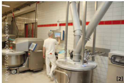
[1] Die Verwiegung der Groß-, Mittel- und Kleinkomponenten erfolgt in einem Raum, der direkt über der Teigmacherei liegt. [2] Alle Zuleitungen der Flüssigkomponenten werden zentral durch die Wand geführt und münden in die fest montierten Abdeckhauben. [3] Die vier Außensilos mit einem Fassungsvermögen von jeweils 30 Tonnen sind schon von weitem gut sichtbar.
