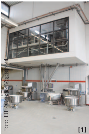
[1] Die Verwiegung der Groß-, Mittel- und Kleinkomponenten erfolgt in einem Raum, der direkt über der Teigmacherei liegt. [2] Alle Zuleitungen der Flüssigkomponenten werden zentral durch die Wand geführt und münden in die fest montierten Abdeckhauben. [3] Die vier Außensilos mit einem Fassungsvermögen von jeweils 30 Tonnen sind schon von weitem gut sichtbar.
