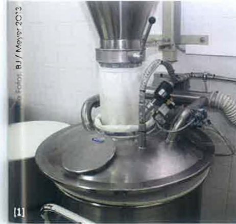
[1] Mehl und temperiertes Wasser gelangen zentral durch die fest installierte Abdeckhaube mit integrierter Absaugung sauber in den Kneterbottich. [2] Zutaten wie beispielsweise Salz oder Backmittel werden von Hand auf der mit dem Optidos-Rezeptcomputer vernetzten Tischwaage verwogen. [3] Die zentrale Bedieneinheit der automatischen Verwiegung bildet die Rezeptursteuerung Optidos mit 15-Zoll-Farbtouchscreen. Hier sind alle Rezepte hinterlegt und vom Teigmacher bequem abrufbar.
