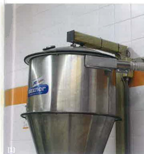
[1] Der 100 Kilogramm Mehl fassende Wiegebehälter ist an einer zentralen Wiegezone aufgehängt. [2] An der Rückwand der Teigmacherei misst ein Fühler die Raumtemperatur, mit der die Steuerung unter Berücksichtigung der Mehltemperatur die korrekte Schüttwassertemperatur errechnet. [3] Neben der rezeptgesteuerten Verwiegung ist selbstverständlich auch die Handeingabe gewünschter Mehl- oder Wassermengen möglich. Auch die derzeitige Füllmenge des Silos wird angezeigt.
