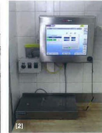
[1] Mehl und temperiertes Wasser gelangen zentral durch die fest installierte Abdeckhaube mit integrierter Absaugung sauber in den Kneterbottich. [2] Zutaten wie beispielsweise Salz oder Backmittel werden von Hand auf der mit dem Optidos-Rezeptcomputer vernetzten Tischwaage verwogen. [3] Die zentrale Bedieneinheit der automatischen Verwiegung bildet die Rezeptursteuerung Optidos mit 15-Zoll-Farbtouchscreen. Hier sind alle Rezepte hinterlegt und vom Teigmacher bequem abrufbar.
