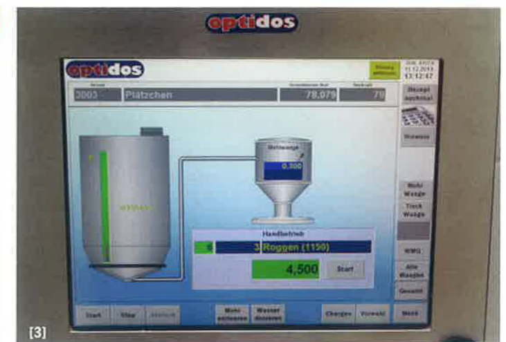
[1] Der 100 Kilogramm Mehl fassende Wiegebehälter ist an einer zentralen Wiegezone aufgehängt. [2] An der Rückwand der Teigmacherei misst ein Fühler die Raumtemperatur, mit der die Steuerung unter Berücksichtigung der Mehltemperatur die korrekte Schüttwassertemperatur errechnet. [3] Neben der rezeptgesteuerten Verwiegung ist selbstverständlich auch die Handeingabe gewünschter Mehl- oder Wassermengen möglich. Auch die derzeitige Füllmenge des Silos wird angezeigt.
