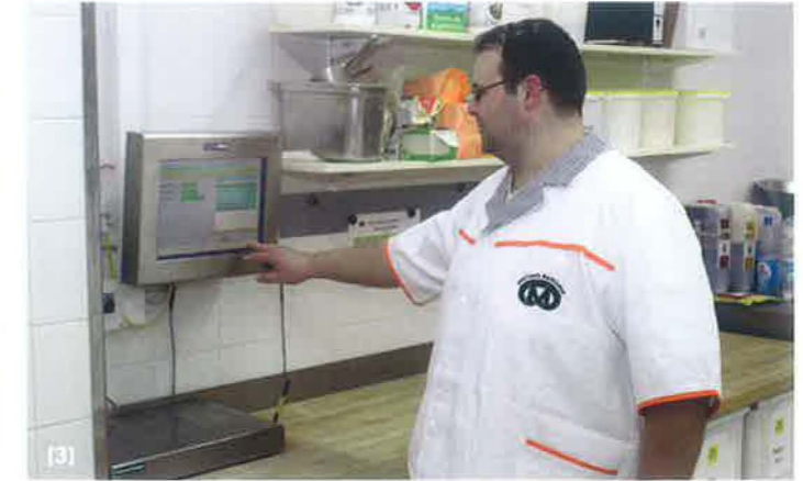
[1] Mehl und temperiertes Wasser gelangen zentral durch die fest installierte Abdeckhaube mit integrierter Absaugung sauber in den Kneterbottich. [2] Zutaten wie beispielsweise Salz oder Backmittel werden von Hand auf der mit dem Optidos-Rezeptcomputer vernetzten Tischwaage verwogen. [3] Die zentrale Bedieneinheit der automatischen Verwiegung bildet die Rezeptursteuerung Optidos mit 15-Zoll-Farbtouchscreen. Hier sind alle Rezepte hinterlegt und vom Teigmacher bequem abrufbar.
