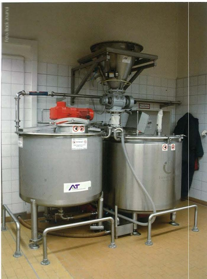
Einer der beiden Behälter, die zur Sauerteigbereitung genutzt werden, war bereits im Betrieb vorhanden und wurde in das neue System integriert.
