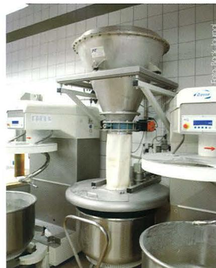
In der zentralen Verwiegung laufen die automatisch dosierten Zutaten Mehl, Wasser und Sauerteig zusammen.
