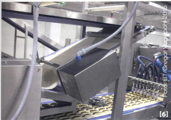
[6] Auf weiteren Fritsch-Linien werden die Blöcke weiter verarbeitet – hier die Herstellung von Kirsch-Vanille-Plunder. [7] Für Gleichmäßigkeit sorgt zunächst der Teigbandvorformer, der den Teig mit einer Sternwalze ölfrei, sanft und gleichmäßig portioniert. [8] Das Teigband wird zunächst in Streifen eingeteilt und anschließend mit einer Guillotine in passende Vierecke geschnitten.
