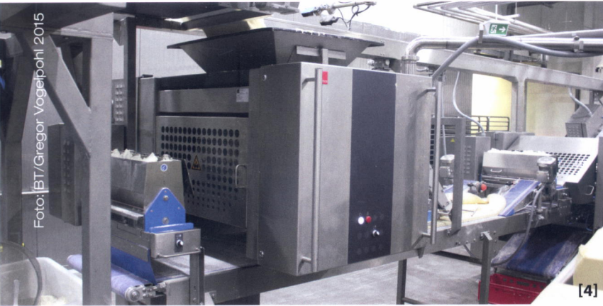
[4] Der Laminator 300 von Fritsch ist geeignet für Bäckereien, die in der Stunde zwischen 200 und 1.000 Kilogramm Teig verarbeiten wollen – bei der Blockherstellung auch bis zu 1.500 Kilogramm. [5] Eine Guillotine schneidet die einzelnen Blöcke, die dann automatisch auf Bleche abgelegt werden.
