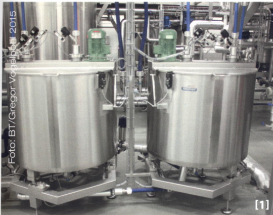
[1] Die Hefe wird aufgelöst, gekühlt und exakt dosiert dem Anteiger für den Weizenvorteig zugeführt. [2] Die Komponenten des Weizenvorteigs werden dem Anteiger kontinuierlich zur Verfügung gestellt und über Anschlüsse an die Mischschnecke gefördert, die eine homogene Masse erzeugt. [3] Die Saaten und Körner für das Quellstück werden nach Produktionsvorgaben zusammengestellt und über zwei Sackeinschütten den Tanks zugeführt.
