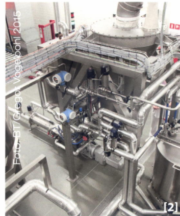
[1] Die Hefe wird aufgelöst, gekühlt und exakt dosiert dem Anteiger für den Weizenvorteig zugeführt. [2] Die Komponenten des Weizenvorteigs werden dem Anteiger kontinuierlich zur Verfügung gestellt und über Anschlüsse an die Mischschnecke gefördert, die eine homogene Masse erzeugt. [3] Die Saaten und Körner für das Quellstück werden nach Produktionsvorgaben zusammengestellt und über zwei Sackeinschütten den Tanks zugeführt.
