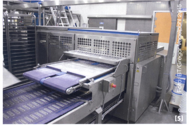
[4] Der Laminator 300 von Fritsch ist geeignet für Bäckereien, die in der Stunde zwischen 200 und 1.000 Kilogramm Teig verarbeiten wollen – bei der Blockherstellung auch bis zu 1.500 Kilogramm. [5] Eine Guillotine schneidet die einzelnen Blöcke, die dann automatisch auf Bleche abgelegt werden.
