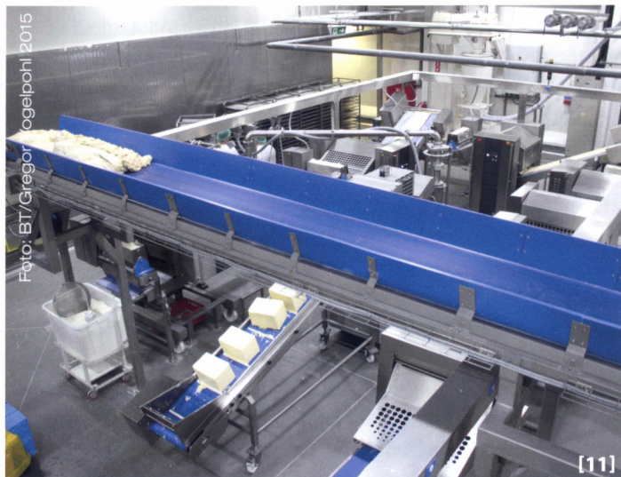
[11] Der Laminator 300 von Fritsch ist in der klassischen U-Form aufgebaut und produziert Plunder- und Blätterteigblocks mit bis zu 144 Fettschichten. [12] Inter Europol stellt mit der Fertigungslinie Impressa Bread wirtschaftlich und rationell rustikale Gebäcke her.
