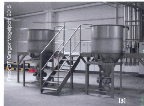
[1] Die Hefe wird aufgelöst, gekühlt und exakt dosiert dem Anteiger für den Weizenvorteig zugeführt. [2] Die Komponenten des Weizenvorteigs werden dem Anteiger kontinuierlich zur Verfügung gestellt und über Anschlüsse an die Mischschnecke gefördert, die eine homogene Masse erzeugt. [3] Die Saaten und Körner für das Quellstück werden nach Produktionsvorgaben zusammengestellt und über zwei Sackeinschütten den Tanks zugeführt.
