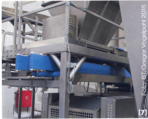
[6] Auf weiteren Fritsch-Linien werden die Blöcke weiter verarbeitet – hier die Herstellung von Kirsch-Vanille-Plunder. [7] Für Gleichmäßigkeit sorgt zunächst der Teigbandvorformer, der den Teig mit einer Sternwalze ölfrei, sanft und gleichmäßig portioniert. [8] Das Teigband wird zunächst in Streifen eingeteilt und anschließend mit einer Guillotine in passende Vierecke geschnitten.
