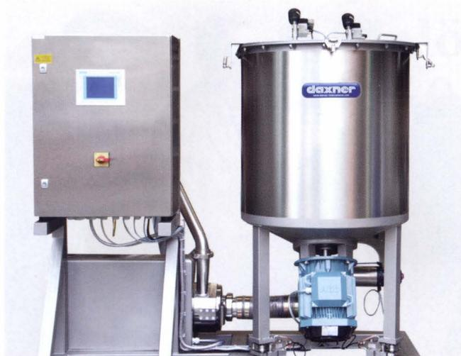
++ „daxRec“ ist eine Verfahrenstechnik zur Feinstzerkleinerung von Restbrot
