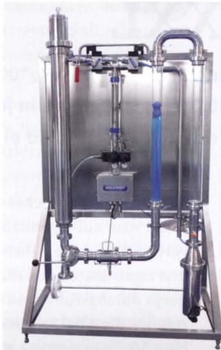
in die Leitungen eingesetzt und von hinten mit Druck belegt werden kann. Nach Absolvieren des vorgesehenen Abschnittes kann der Molch über spezielle Stationen auch herausgenommen werden. Die entsprechenden molchbaren Armaturen können den Leitungsquerschnitt vollständig öffnen, wie z. B. Kugelhähne und Absperrschieber.
