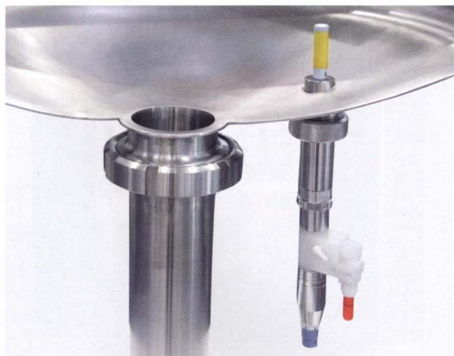
++ Zur permanenten Überwachung des Fermentationsprozesses hat Daxner „daxpH+“ entwickelt
