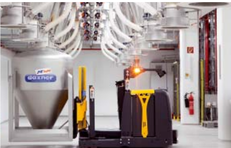
Vollautomatisches Absammelsystem auf Basis des Daxner-Container-Systems im Zusammenwirken mit drei fahrerlosen Transportfahrzeugen
