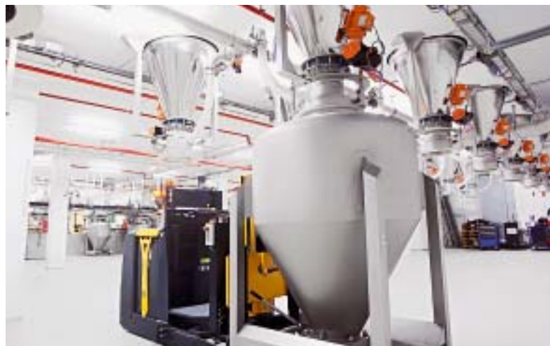
Lasergesteuertes fahrerloses Transportsystem mit Sammelcontainer der DCHD-Baureihe, die im Hygienic Design ausgeführt ist
