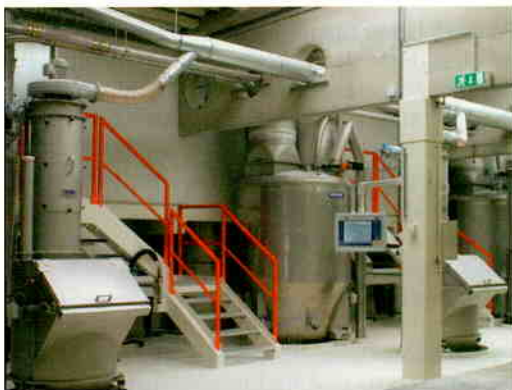
Die Aufschüttstationen für Sackware sind mit Kontroll-siebmaschinen ausgerüstet
