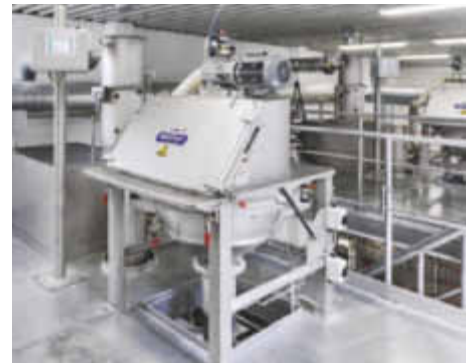
Vib-&-Press-Aufgabestation im Hygienic Design für die Aufgabe von Produkten mit schlechten Fließeigenschaften
