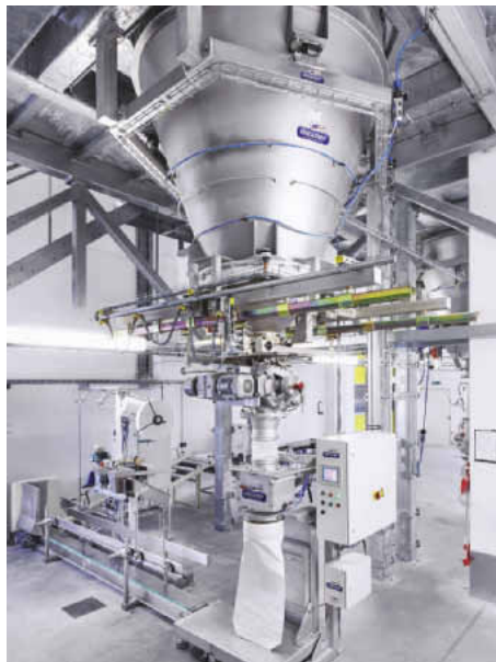
Gravimetrische Absackwaage DAX-PVS zur Abfüllung der fertigen Mischung in Verkaufsgebinde
