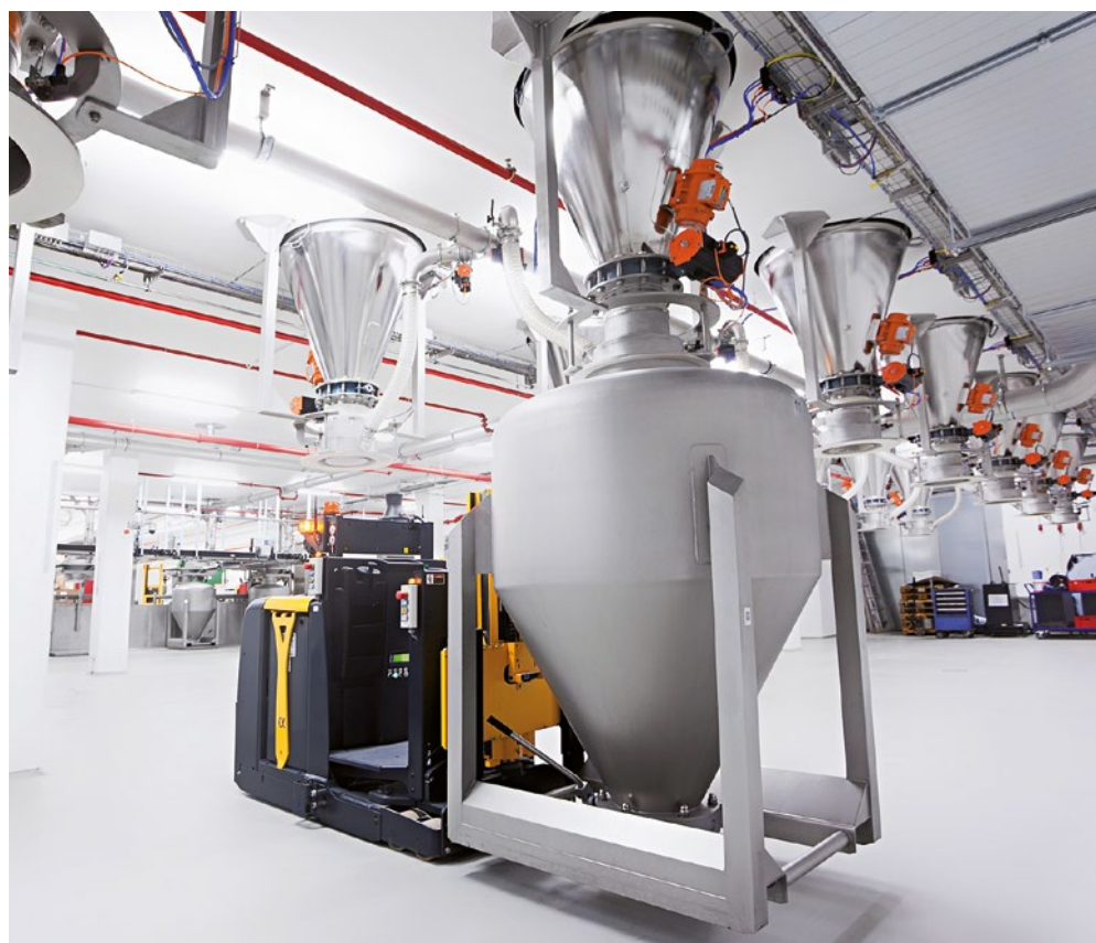
Lasergesteuerte FTF (fahrerlose Transportfahrzeuge) mit Daxner Container Hygienic Design DCHD
