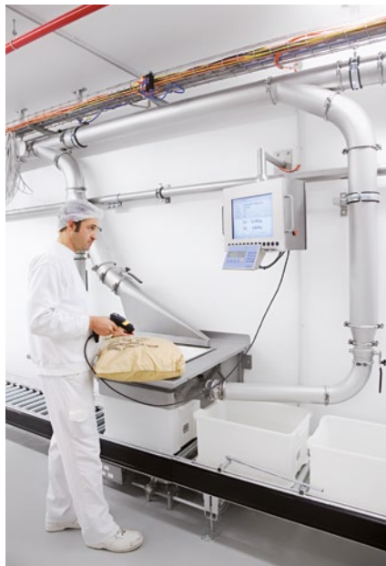
Umwidmung Aufgabe Sackware in PU-Wannen Einlagerung in das automatische Kleinkomponentenlager KKL
