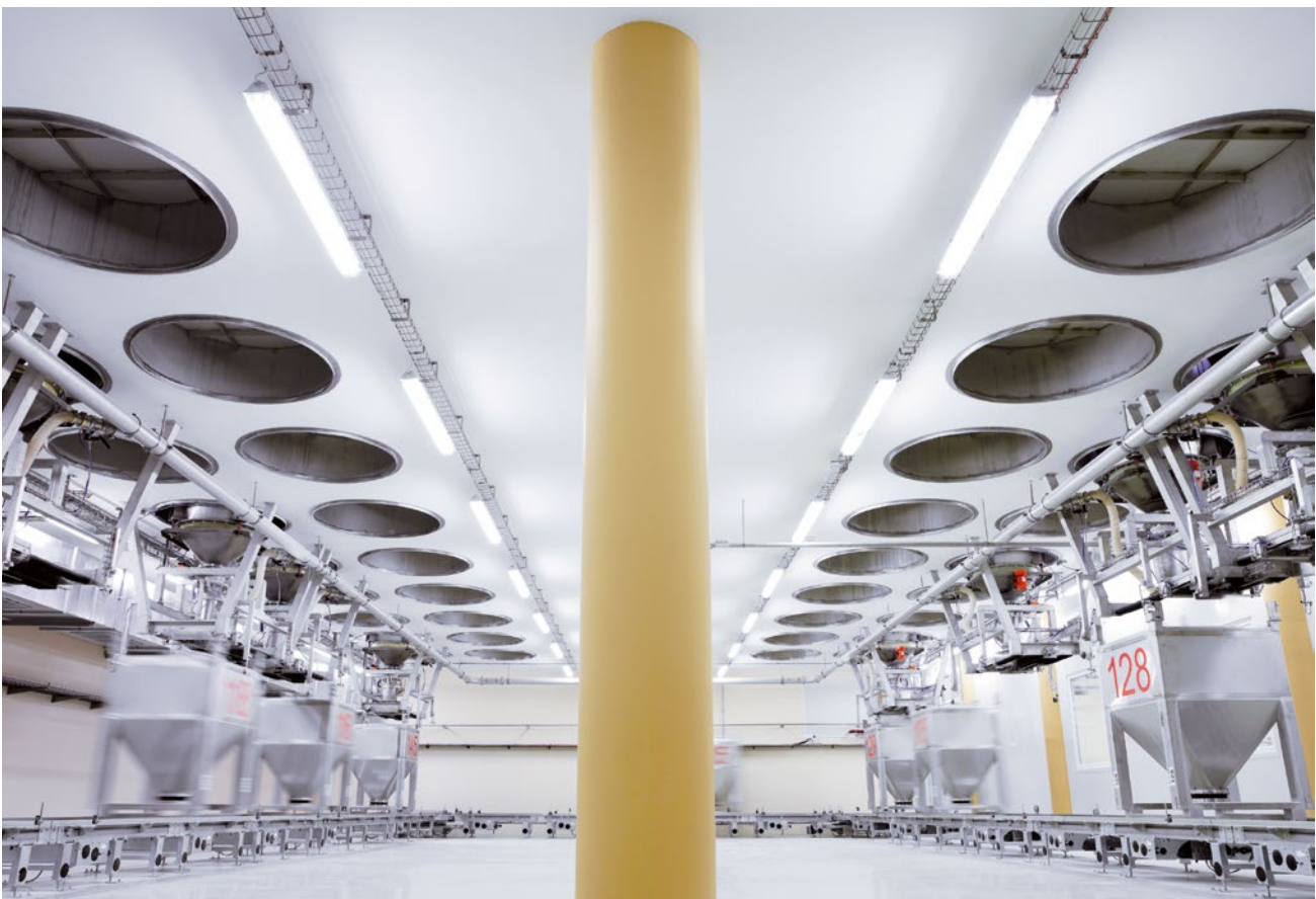
Containertransportsystem und Deckelmanipulator zum Absammeln der vordosierten Einzelkomponenten
