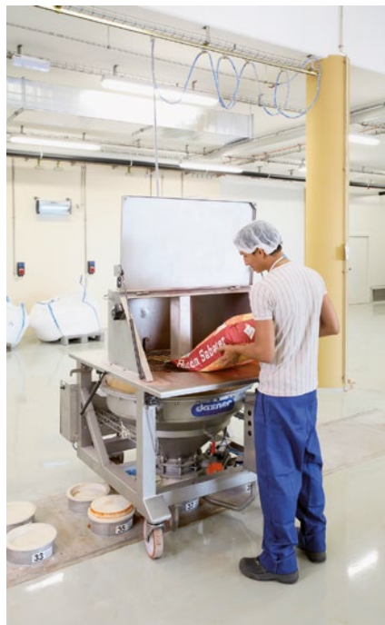
Rohstoffbefüllung über fahrbare Sackaufschüttung VIB & PRESS mit Rührwerk und Kontrollsiebmaschine
