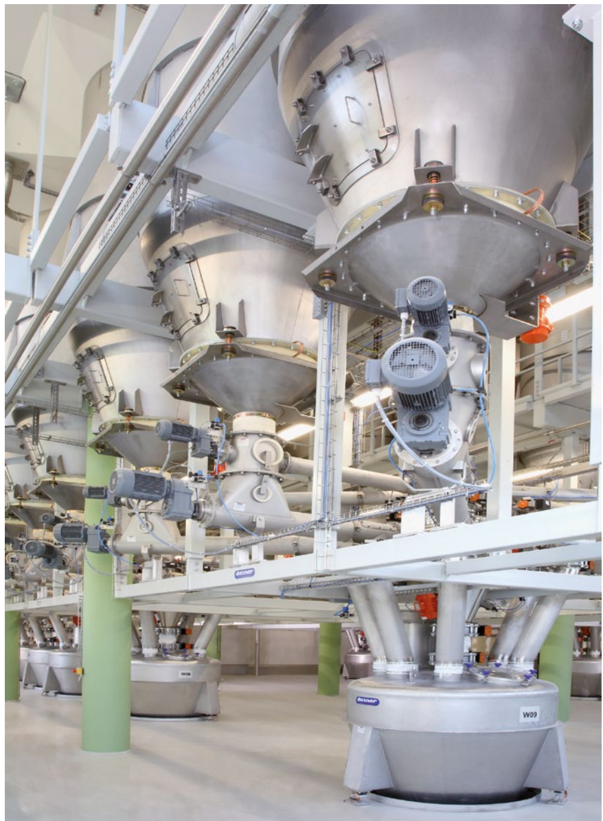
Rohstoff-Dosierung mittels getrennter Dosierschnecken sowie Wiegebehälter
