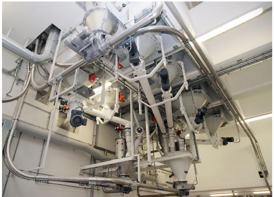
Austragsystem mit pneumatischer Druckförderung
