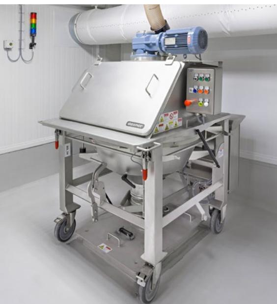
Vorkommissionierte Kleinkomponenten werden mittels manuellen Aufgabestationen VIB & PRESS direkt in den Container aufgegeben
