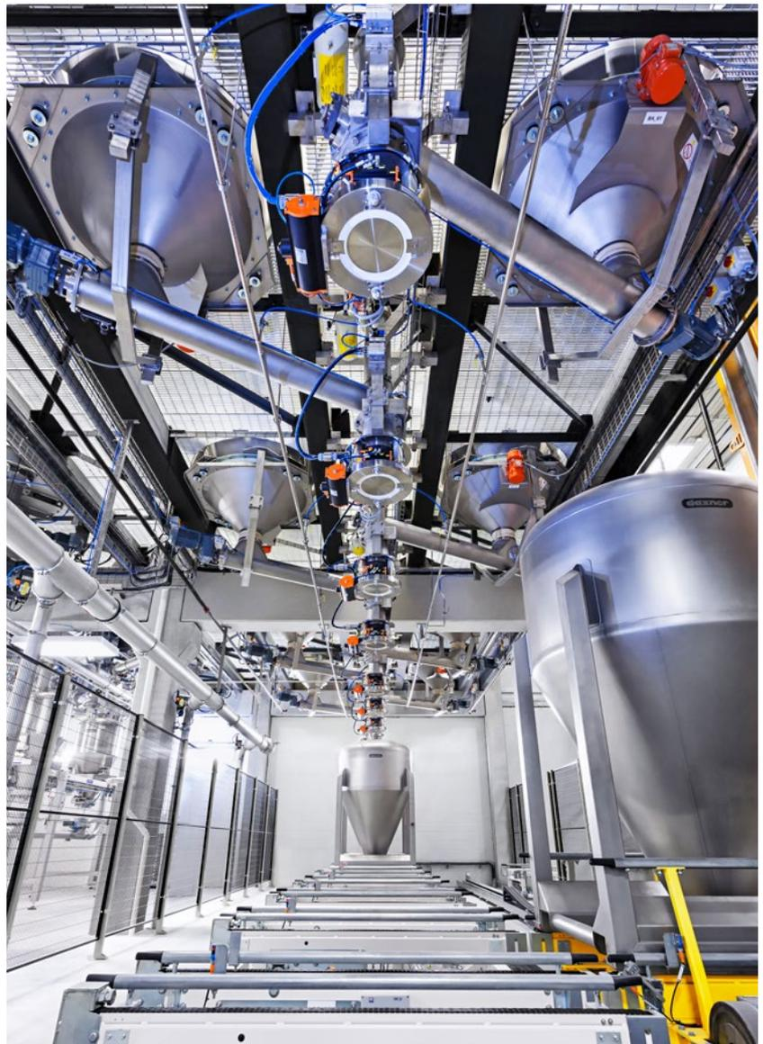
Das in die Mischanlage integrierte dreidimensionale Containertransportsystem transportiert die Behälter vollautomatisch zu allen Absammelstellen für die Mittel- und Kleinkomponenten
