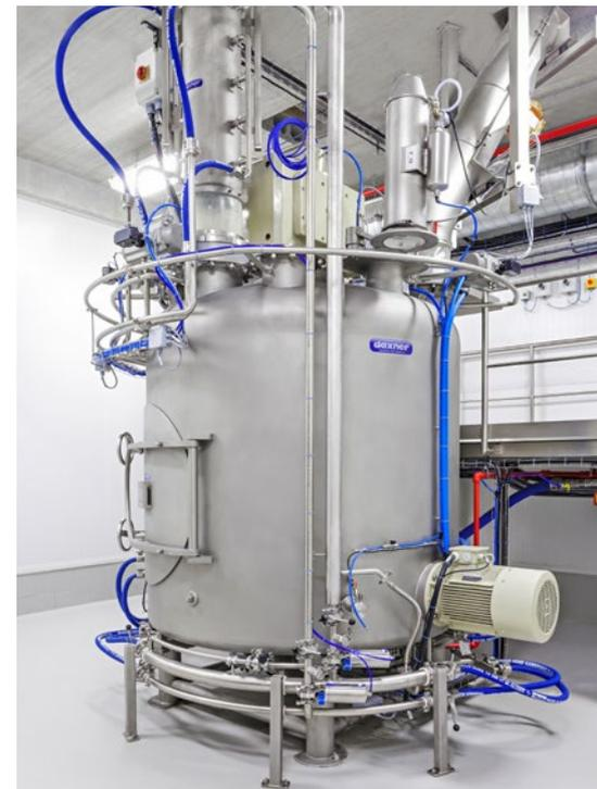
Der CIP-fähige Mischer sorgt für höchste Mischgenauigkeit (1:100.000) für Pulvermischungen inklusive der Zugabe von Blockfett bzw. Flüssigfetten
