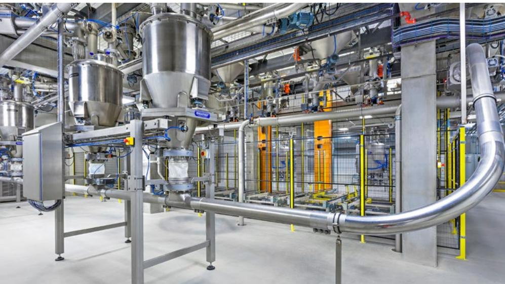
Hohe Genauigkeit beim Dosieren und Verwiegen der Backzutaten mittels pneumatischem Fördersystem
