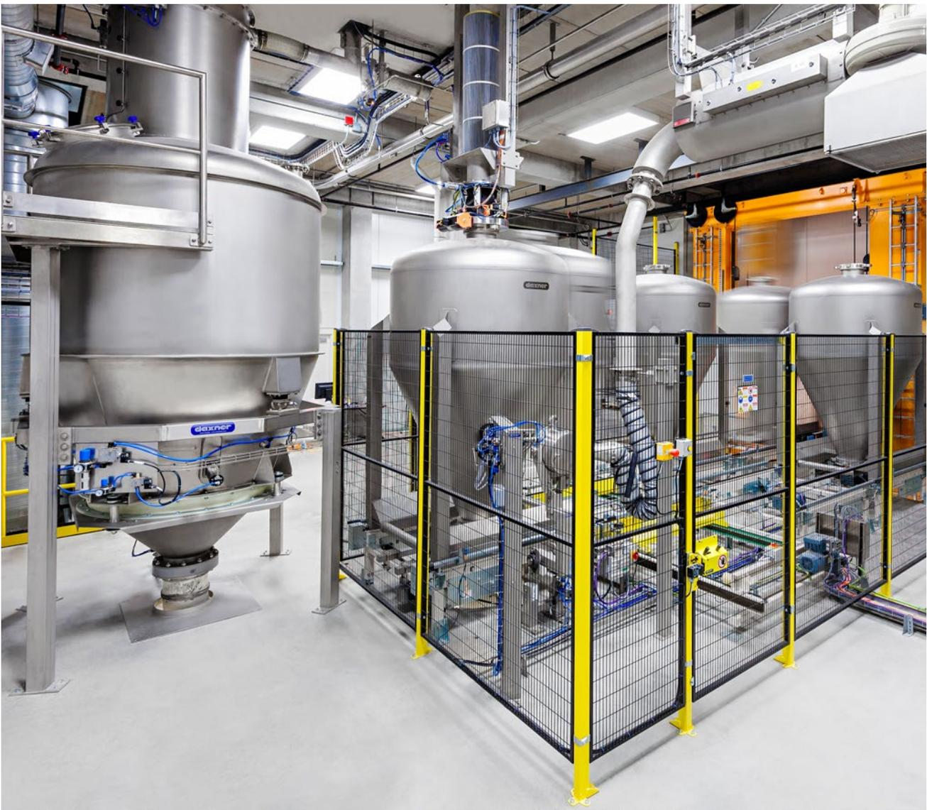
Flexibles, automatisiertes Misch- und Dosiersystem für die Herstellung verschiedenster fertiger Backmittelmischungen aus einer Vielzahl von Einzelkomponenten
