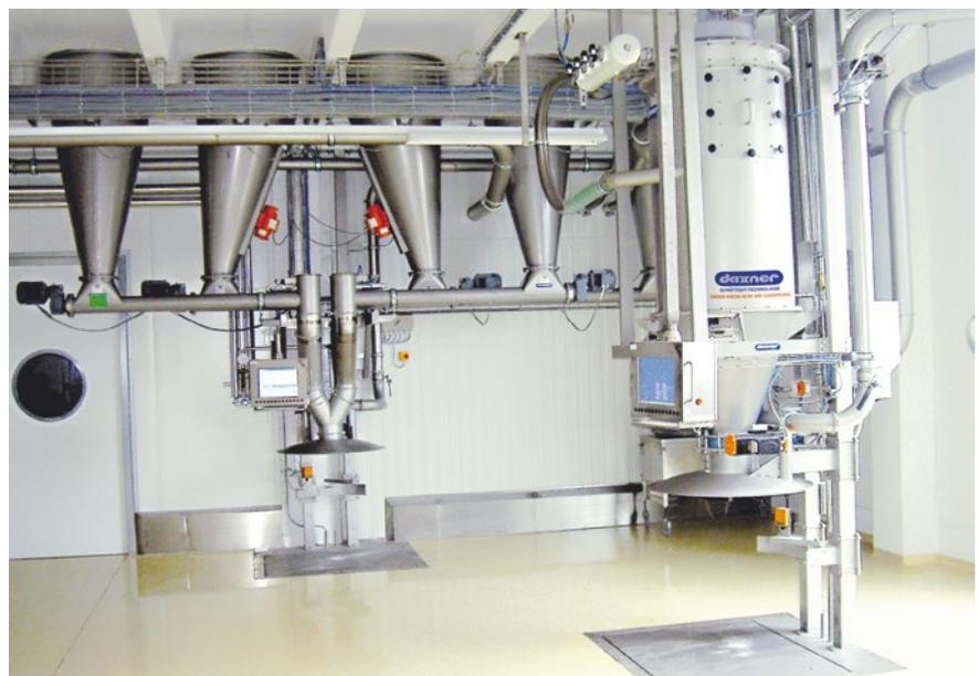
Automatische Zuführung und Dosierung der Komponenten in die Teigschalen
