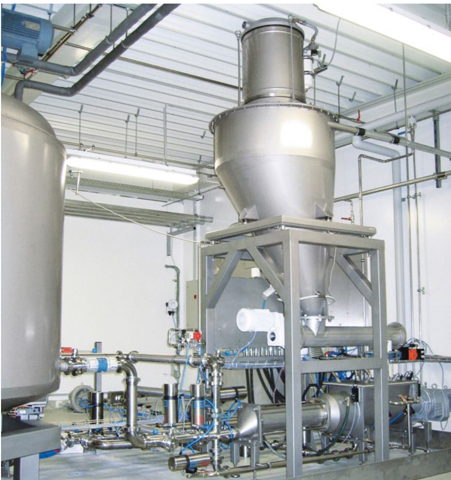
Vorteige werden im kontinuierlichen Anteiger daxDou gemischt und gelangen über Rohrleitungen von unten ausgehend in die Reifebehälter.
