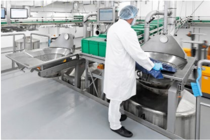
Nach dem Einsammeln der automatisch dosierten Komponenten wird der Container unter Handaufgabestationen positioniert. Hier werden alle Kleinkomponenten als Ganzgebilde und/oder Teilmengen aus
