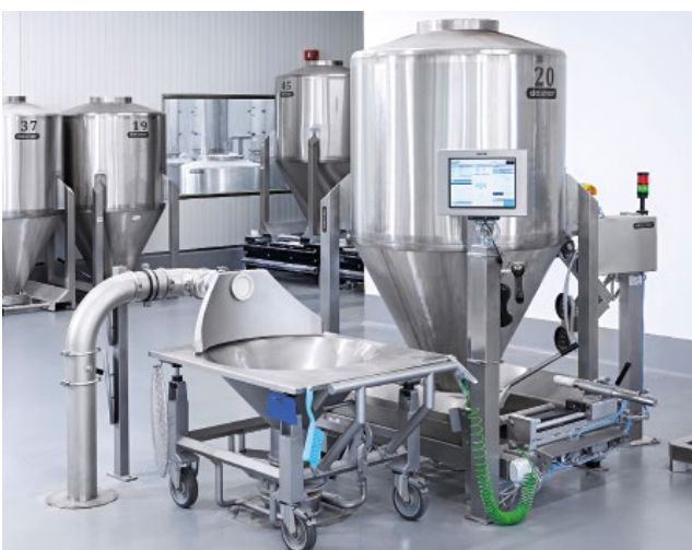
Container-Entleersystem mit automatischem Klappenöffner; Mobile Sackaufgabestation.
