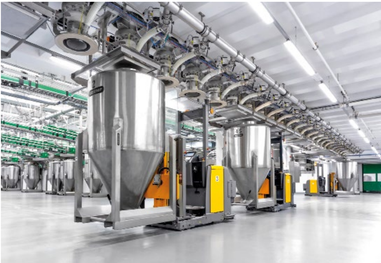
Vollautomatisches Absammelsystem mittels Daxner Container Systems DCS in Verbindung mit Fahrerlosem Transportsystem FTS Container der Serie DCHD in Hygienic Design, Nutzinhalt 1.200 Liter, CIP-fähig
