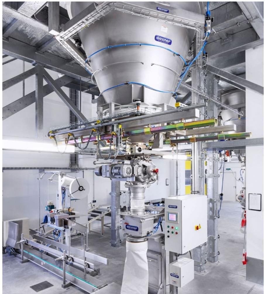
Gravimetrische Absackwaage DAX-PVS zur Abfüllung der fertigen Mischung in Verkaufsgebinde
