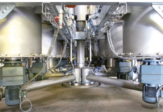
Rührwerkstragapparate RA Dosierschnecken mit Flow-Stop Verschlusskappe für höchste Dosiergenauigkeit
