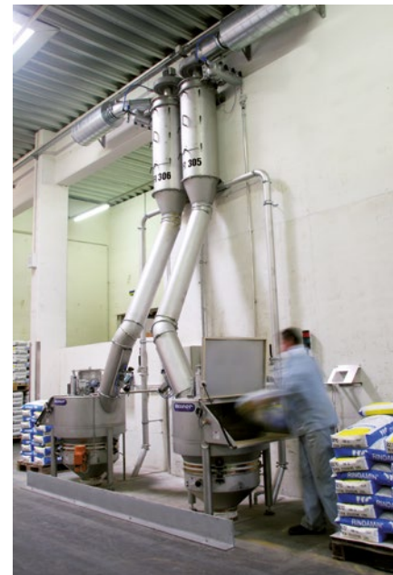
Kombinierte Sack- und Big-Bag Aufgabestationen Kontrollsiebmaschine KS700 Aspirationssystem mit Radialventilator und Düsenfilter
