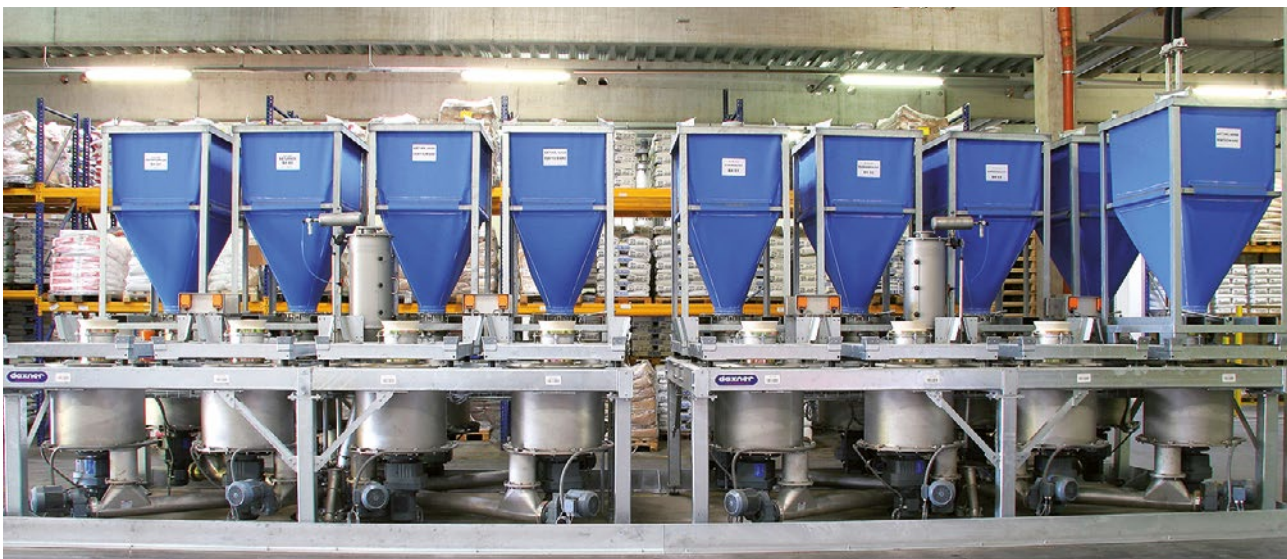
Kleinkomponenten-Container-Dosieranlage 2 x 8 Komponenten Produktaufgabe mit Containersystem Zwischenbehälter mit Rührwerk-Austragapparat Dosierschnecke mit Flow-Stop
