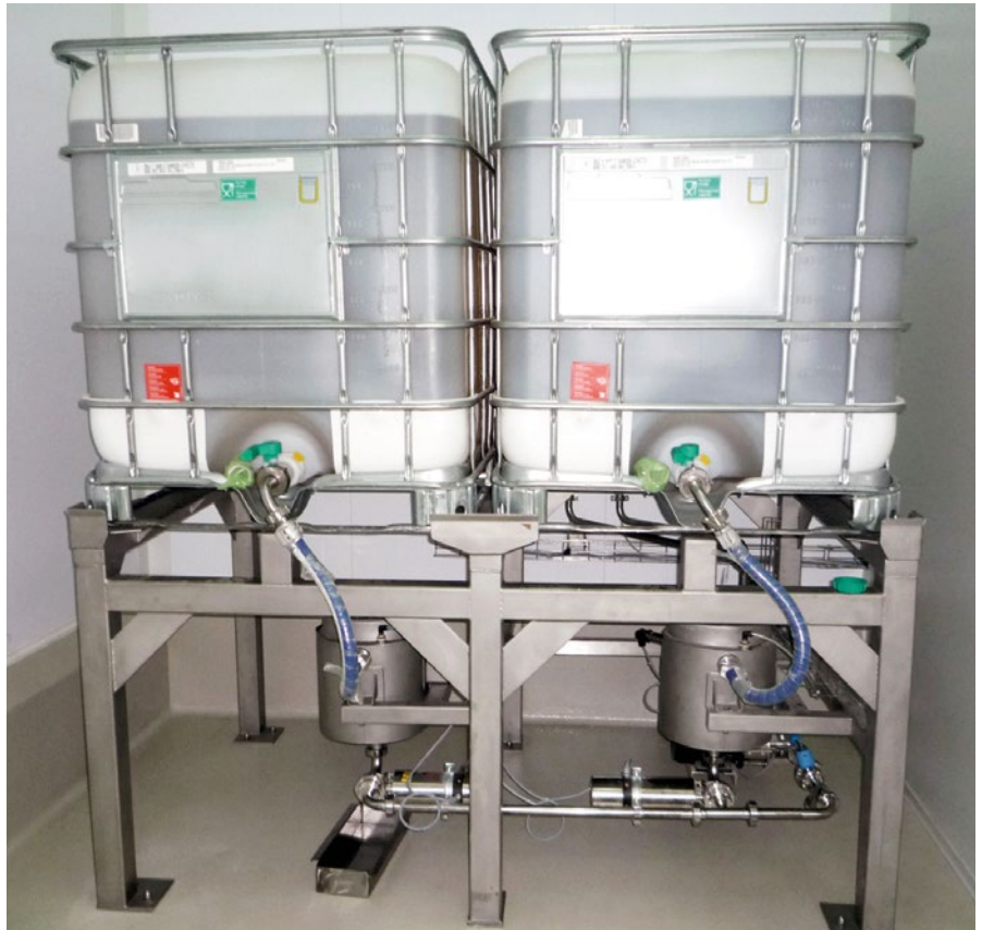
Zwei Tanks sorgen für die ausreichende Menge Öl, das über eine Pumpe zum Anteiger und Knetern gefördert wird.
