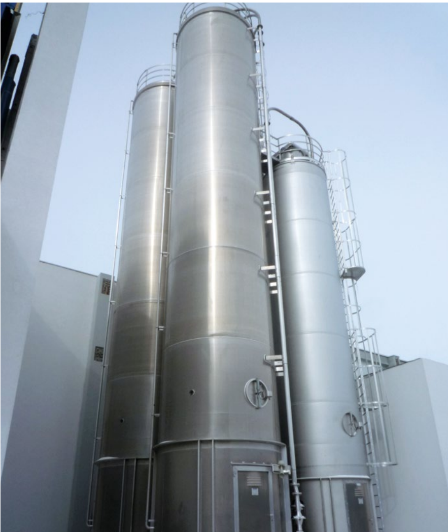
Das 30 Tonnen Zuckersilo und die drei 50 Tonnen Mehlsilos befinden sich im Außenbereich der Bäckerei. Das Mehl für die Produktion liefert die zum Konzern gehörige Mühle.
