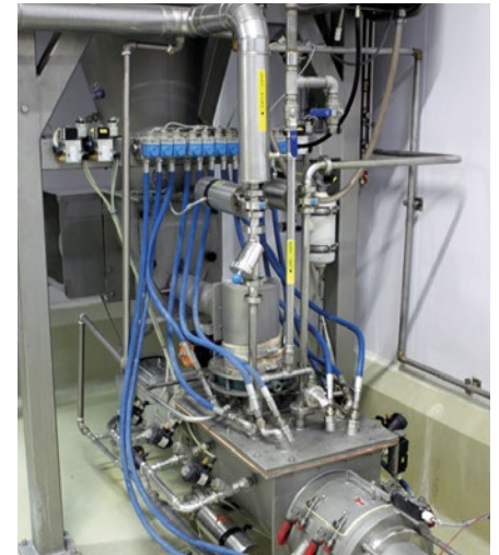
Mehl, Wasser, Hefe und Öl vermischen sich im Anteiger zum Vorteig, der dann in die Reifebehälter gepumpt wird.
