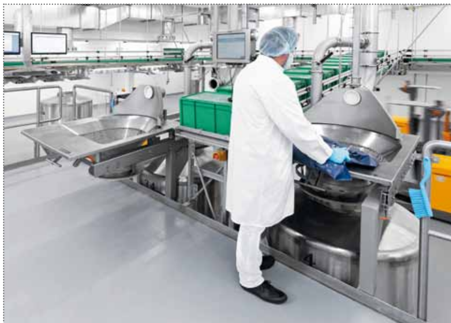
Nach dem Einsammeln der automatisch dosierten Komponenten wird der Container unter Handaufgabestationen positioniert. Hier werden alle Kleinkomponenten als Ganzgebinde und/oder Teilmengen aus dem KKL abgegeben.
