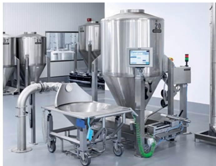
■ Abb. 3: Container-Entleersystem mit automatischem Klappenöffner; Mobile Sackaufgabestation.
