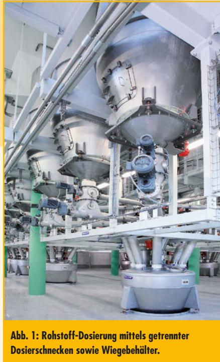
**Abb. 1: Rohstoff-Dosierung mittels getrennter Dosierschnecken sowie Wiegebehälter.**
