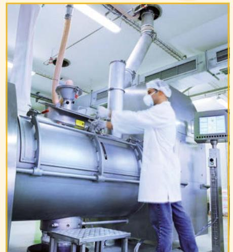
**Abb. 2: Entsprechend Chargen-Größe und Rezeptur unterscheiden sich die acht separaten Mischlinien bezüglich der Größe des Mixers sowie des eingesetzten Mischsystems. So erzielen sie höchstmögliche Mischgenauigkeit und -leistung bei maximaler Produktschonung.**
