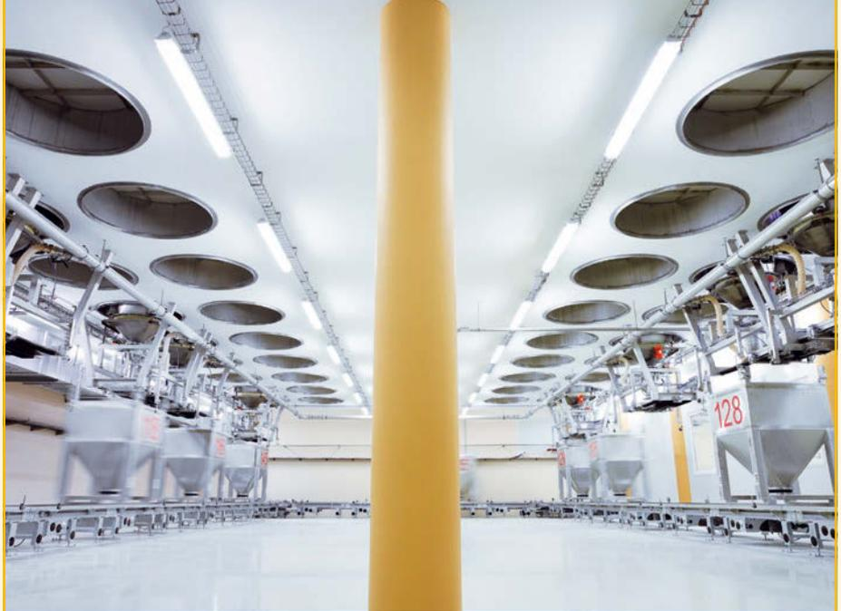
Abb. 3: Containertransportsystem und Deckelmanipulator zum Absammeln der vordosierten Einzelkomponenten.
