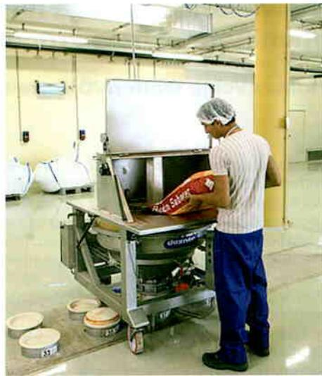
Abb. 3: Rohstoffbefüllung über eine fahrbare Sackaufschüttung „Vib & Press“ mit Rührwerk und Kontrollsiebschiene
