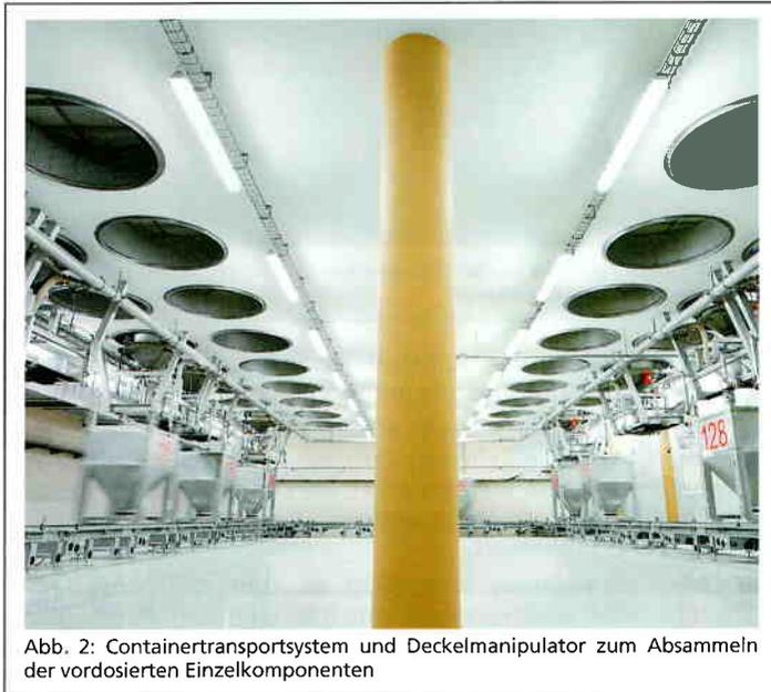
Abb. 2: Containertransportsystem und Deckelmanipulator zum Absammeln der vordosierten Einzelkomponenten
