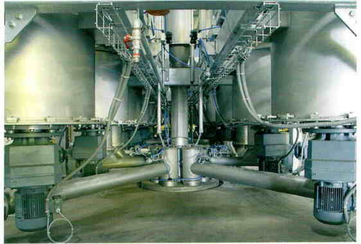
Abb. 4: Rührwerkaustragapparate RA, Dosierschnecken mit Flow-Stop-Verschlußklappe für höchste Dosiergenauigkeit
