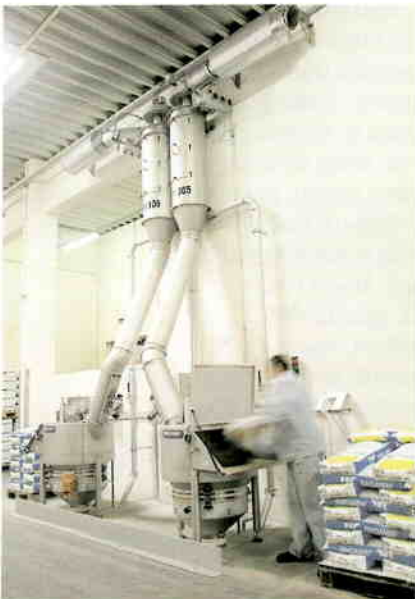
Abb. 1: Kombinierte Sack- und Big-Bag-Aufgabestationen mit Kontrollsiebmaschine KS700 und einem Aspirationssystem mit Radialventilator und Düsenfilter Alle Abb.: Ing. Johann Daxner GmbH, Wels/Oberösterreich
