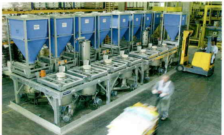
Abb. 2 (oben und unten): Kleinkomponenten-Container-Dosieranlage (zwei Dosierstationen mit je acht Containerplätzen, also 2 x 8 Komponenten), Produktaufgabe mit Containersystem, Zwischenbehälter mit Rührwerk-Austragapparat, Dosierschnecke mit Flow-Stop
