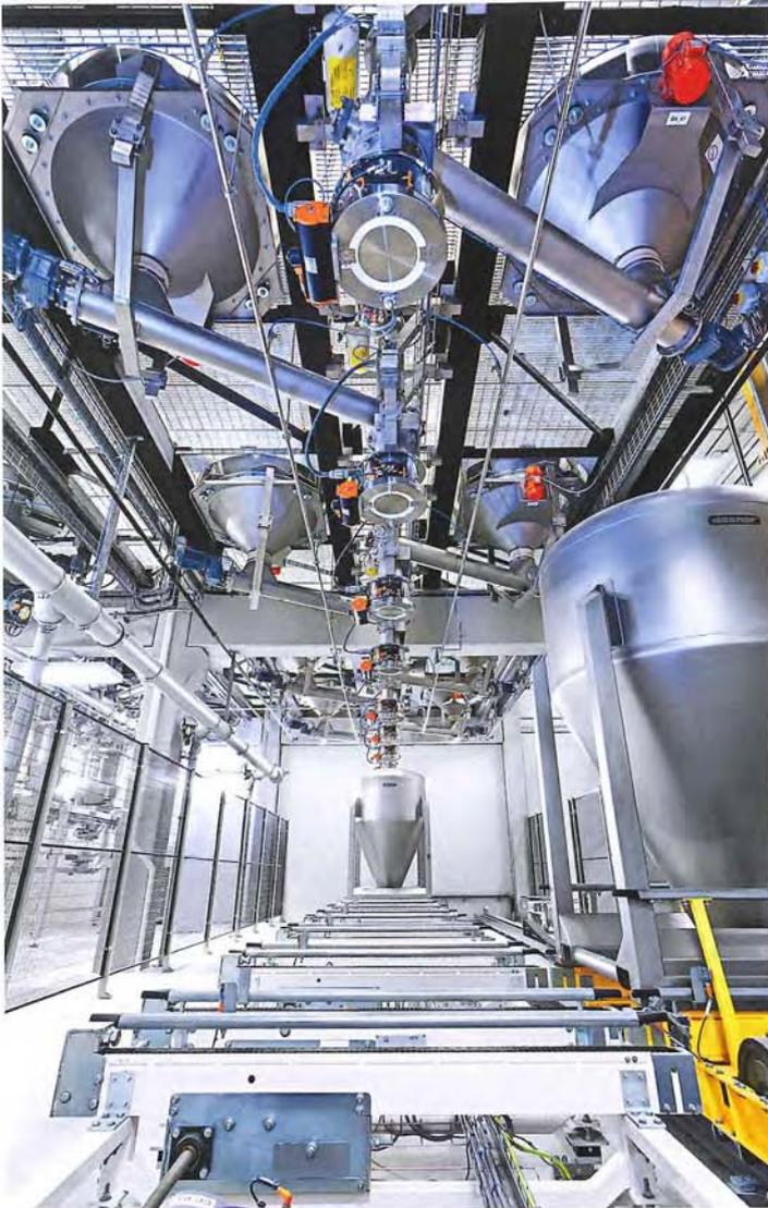
Abb. 3: Container-Aufnahmesystem für Mittel- und Kleinkomponenten
