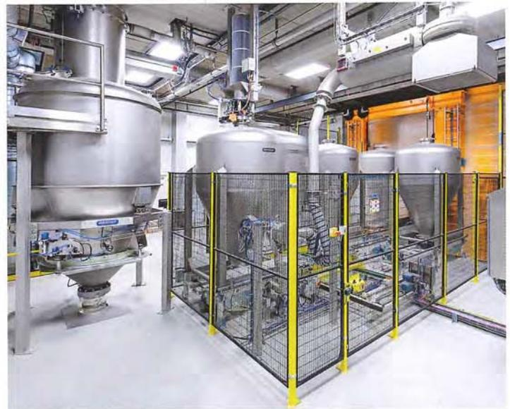
Abb. 4: Vollautomatische Mischerbeschickung durch Saugwaagen (Außensilos) und ein drei-dimensionales Container-Transportsystem
