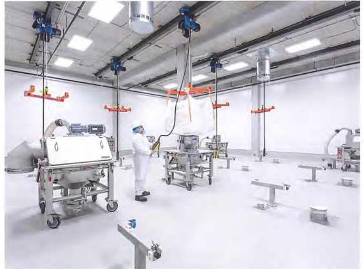
Abb. 2: Mittelkomponenten werden in Tagessilos gelagert und mittels mobilen Aufgabestationen mit integrierten Kontrollsiebmaschinen befüllt.
