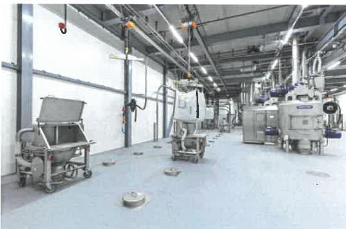
Abb. 1: Kontaminationsfreie Tagessilobefüllung und Vertikalmischer im Hygienic Design alle Fotos: Daxner GmbH
