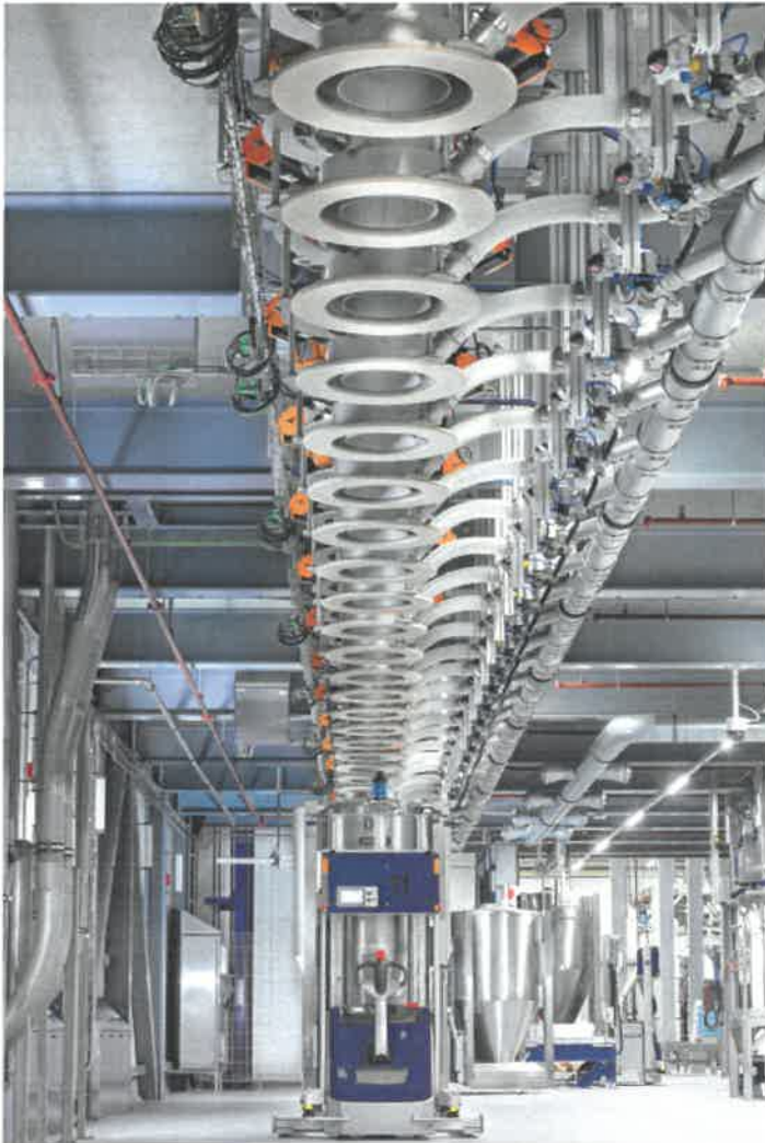
Abb. 4: Vollautomatische Zusammenstellung mittels Containersystem DCS von Daxner in Verbindung mit fahrerlosen Transportfahrzeugen
