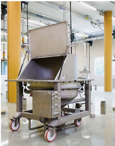
◀ Rohstoffbefüllung über fahrbare Sack- und Big Bag- Aufgabestationen sowie fahrbaren VIB & PRESS Kontrollsiebmaschinen mit Rührwerk für schwierige Produkte
