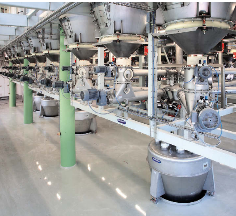
▲ Rohstoff-Dosierung mittels getrennter Dosierschnecken sowie Wiegebehälter
