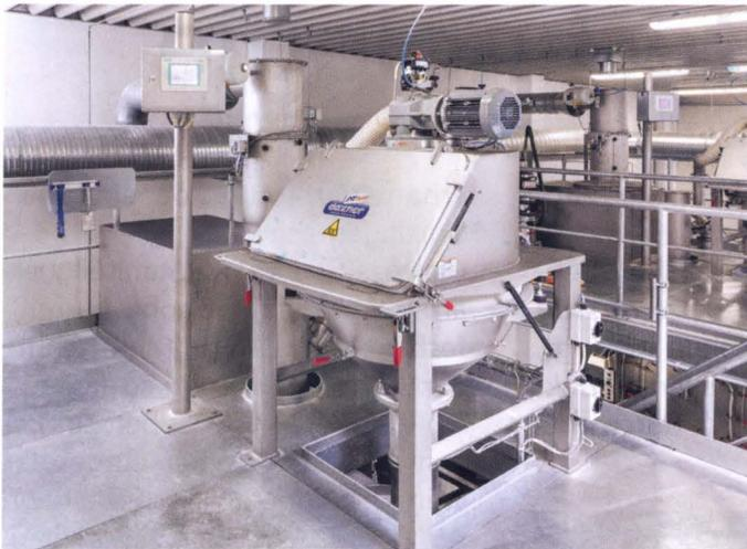
**Kontrollsiebmaschine VIB & PRESS für schwer fließende Produkte**
