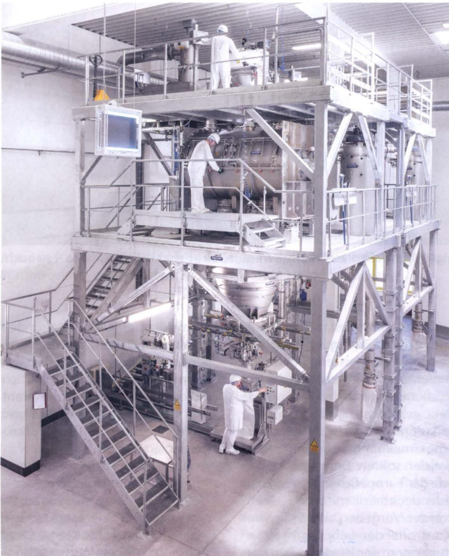
Kompakt ausgeführte Spezialmischanlage für die Herstellung komplexer Backmittel
