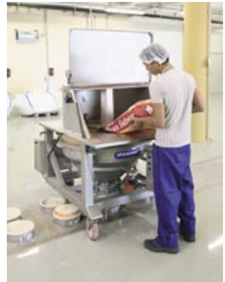
Rohstoffbefüllung über die fahrbare Sackaufschüttung
