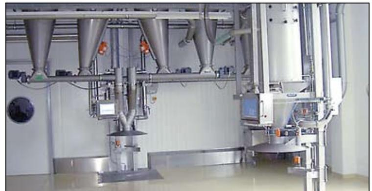
*Automatische Zuführung und Dosierung der Komponenten in die Teigschalen.*
