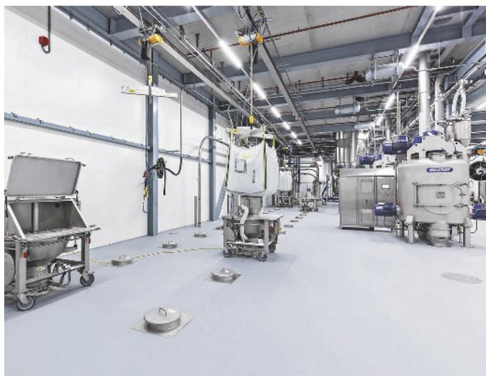
Kontaminationsfreie Befüllung der Tagessilos mit Big Bags. Rechts im Bild ein Vertikalmischer im Hygienic Design.
