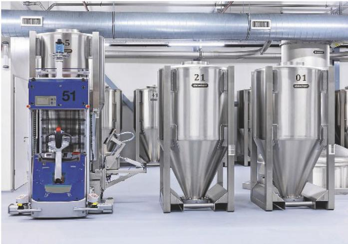
Die Container werden mittels fahrerlosem Transportsystem durch die Anlage bewegt
