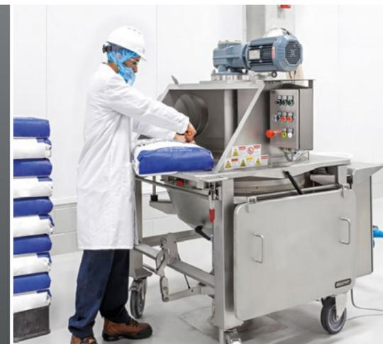
Estaciones de vaciado de bolsas con tamizadora de control integrada para la seguridad de su producción
