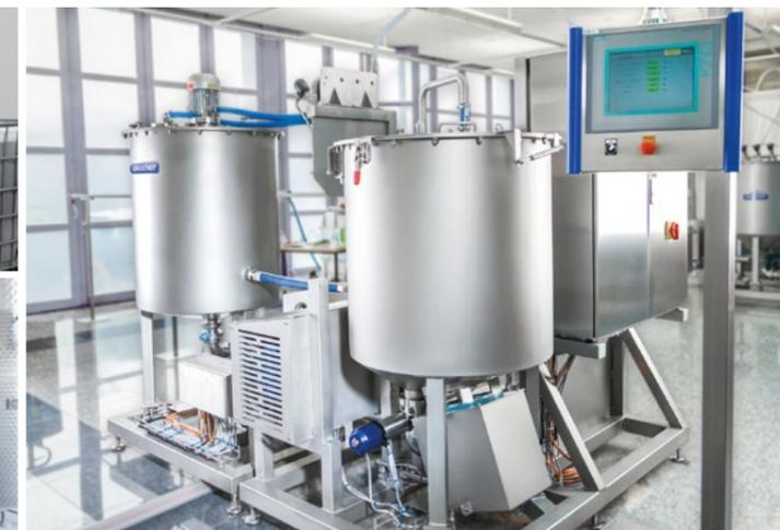
Para la preparación húmeda del pan sobrante: mezclador de pan sobrante de Daxner
