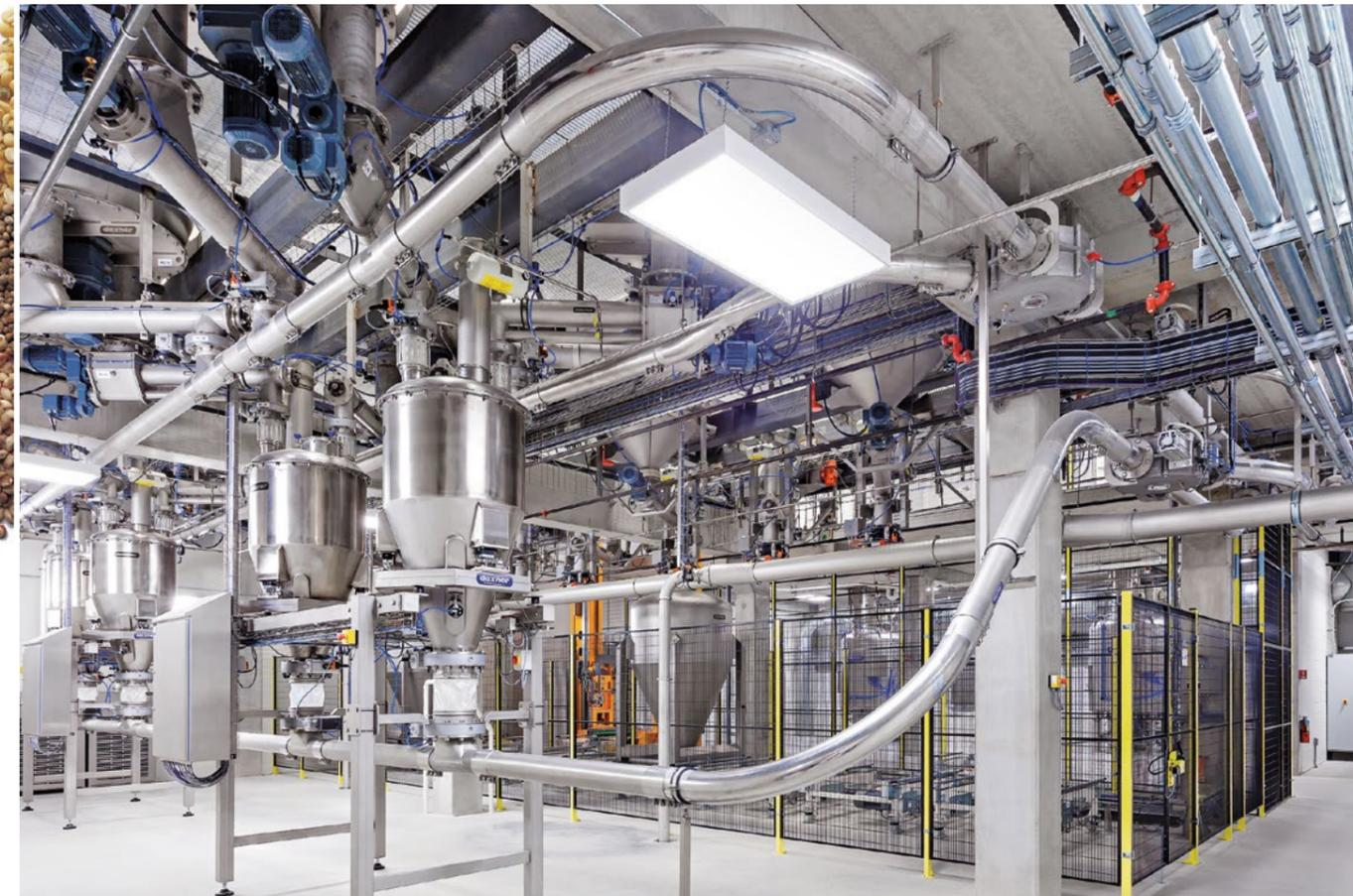
Пневматический конвейер всасывающего типа в комбинации с контейнерной системой DCS Daxner Container Systems
