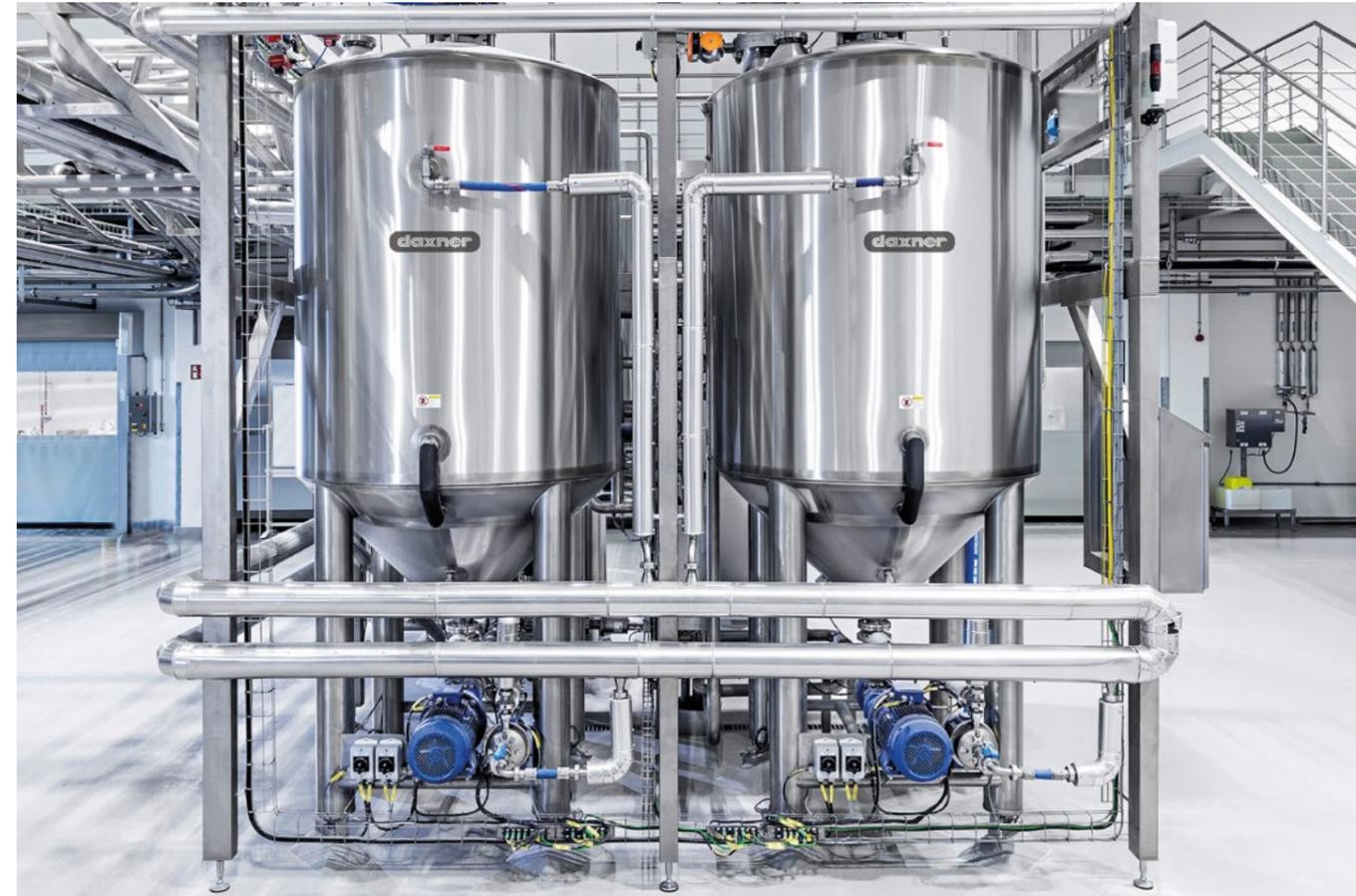
Бункер созревания для любой опары/ закваски - с пиггинг - системой - для выгрузки продукта и чистого разделения следующих друг за другом партий продукта
