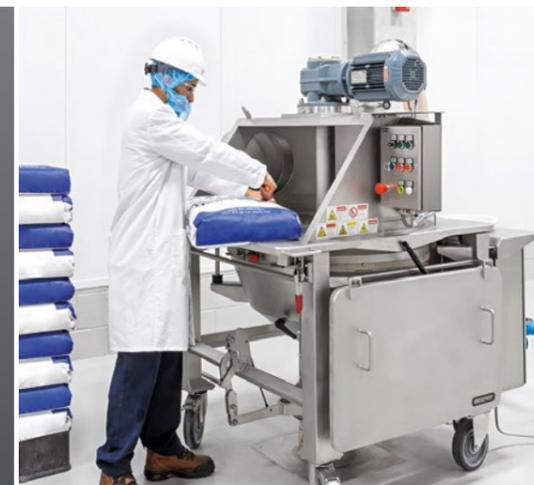
Досконально продуманные станции загрузки мешков со встроенным ситом обеспечат высокую надежность производства
