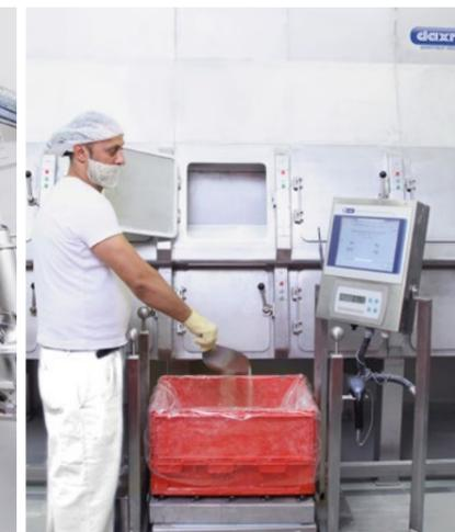
Ручная система дозирования для мелких и микрокомпонентов
