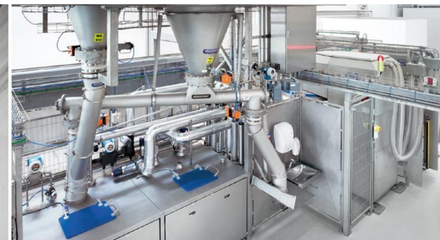
Полностью автоматическая подача на тестомеситель твердых и жидких компонентов
