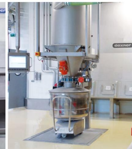
Bodenwaage zur (Kontroll-)Verwiegung
