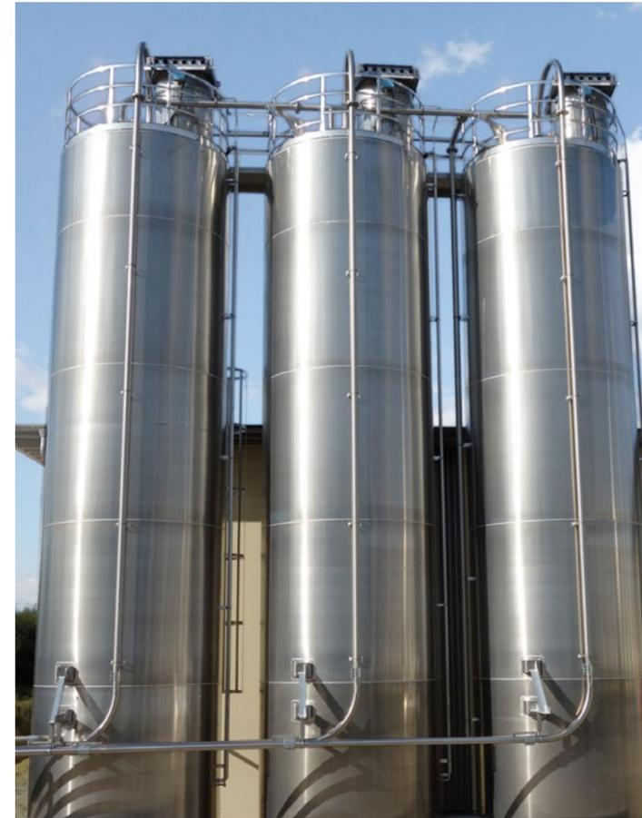
Außensilos in geschweißter Ausführung zur Lagerung von Mehl, Zucker, etc.
