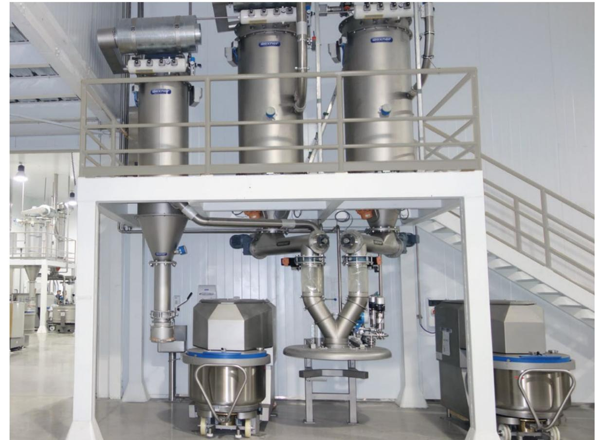
Automatische Kneterschickung mittels Dosierung im Abzugsverfahren
