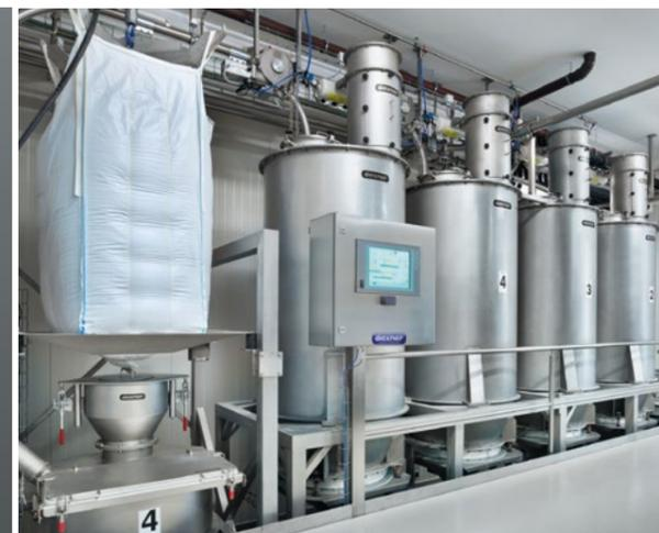
Kombinierte Big-Bag- und Sackentleerstation und Tagessilos für Mittelkomponenten
