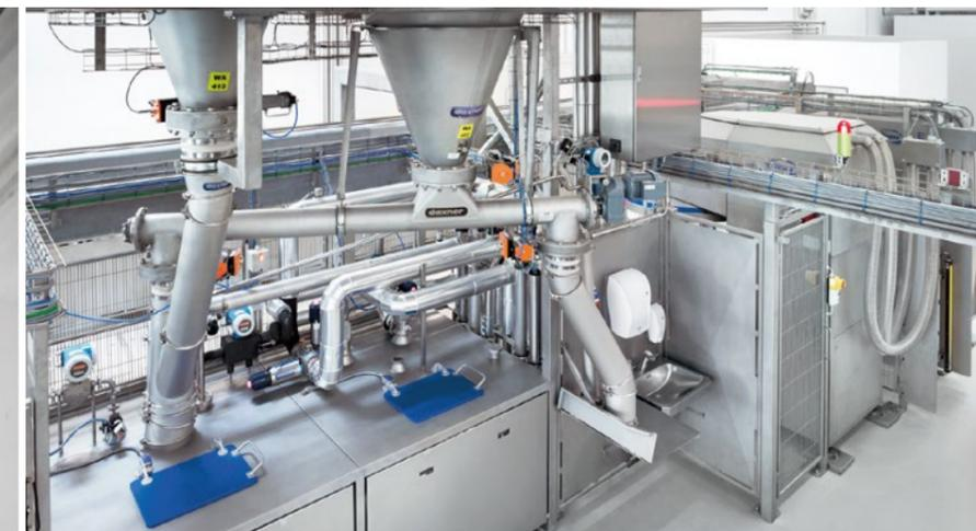
Vollautomatische Kneterschickung mit festen und flüssigen Zutaten
