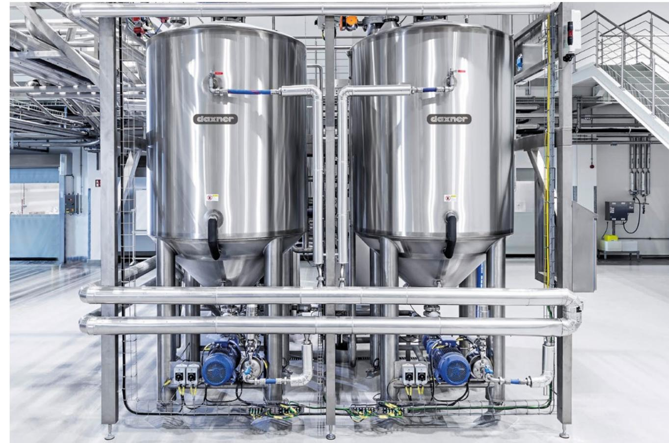
Reifebehälter für jeden Vorteig/Sauerteig - Ausführung mit Molchsystem zum Produktaus Schub sowie zur sauberen Trennung aufeinanderfolgender Produktchargen
