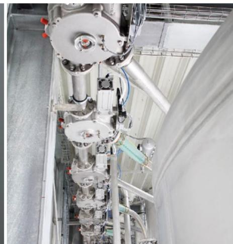
Einzelkomponenten (u.a. Schleusen, Weichen, Quetschventile) runden das Programm ab
