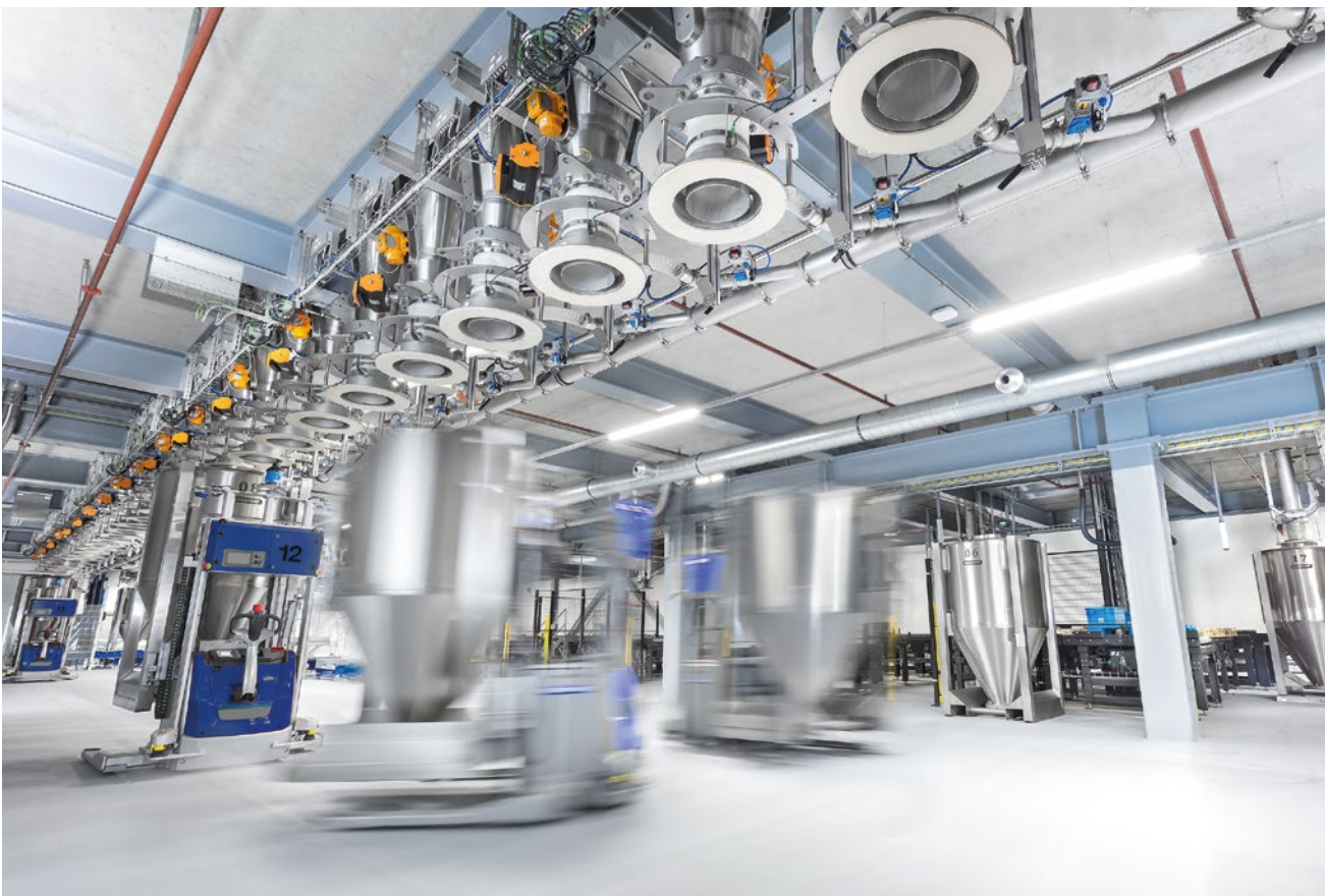
Vollautomatisches Absammelsystem mittels Daxner Container System DCS in Verbindung mit FTS System.
