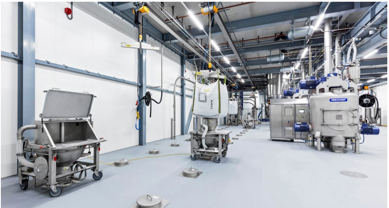
Kontaminationsfreie Befüllung der Tagessilos mit Big Bags. Rechts im Bild ein Vertikalmischer im Hygienic Design.
