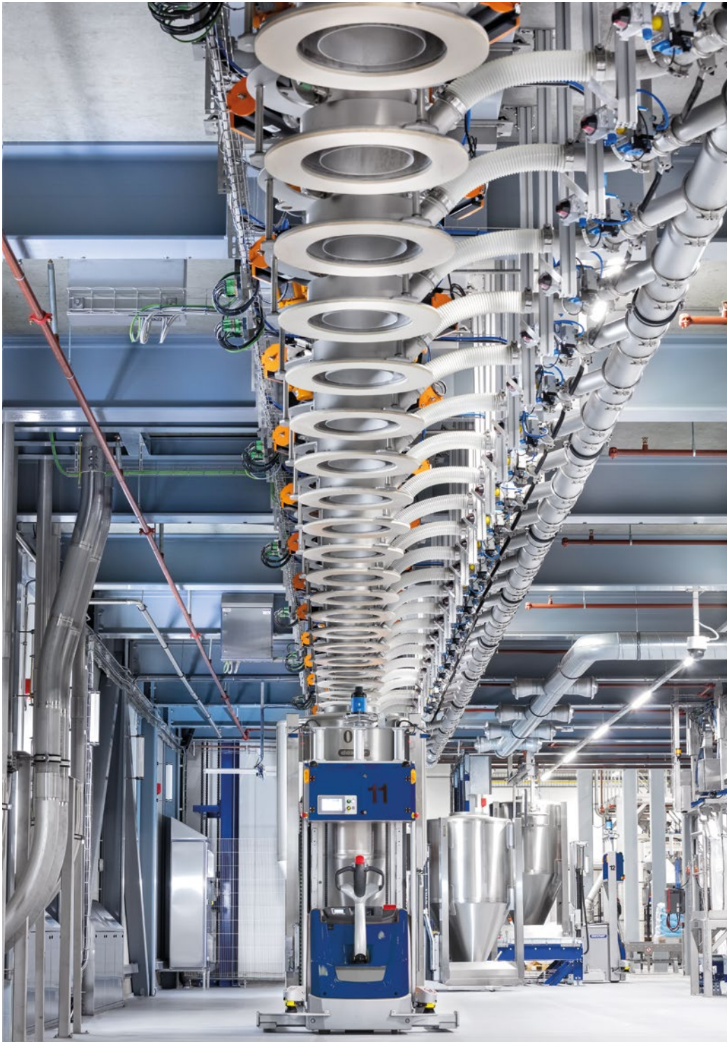
Vollautomatisches Absammelsystem mittels Daxner Container Systems DCS in Verbindung mit FTS System (Fahrerloses Transportsystem).
