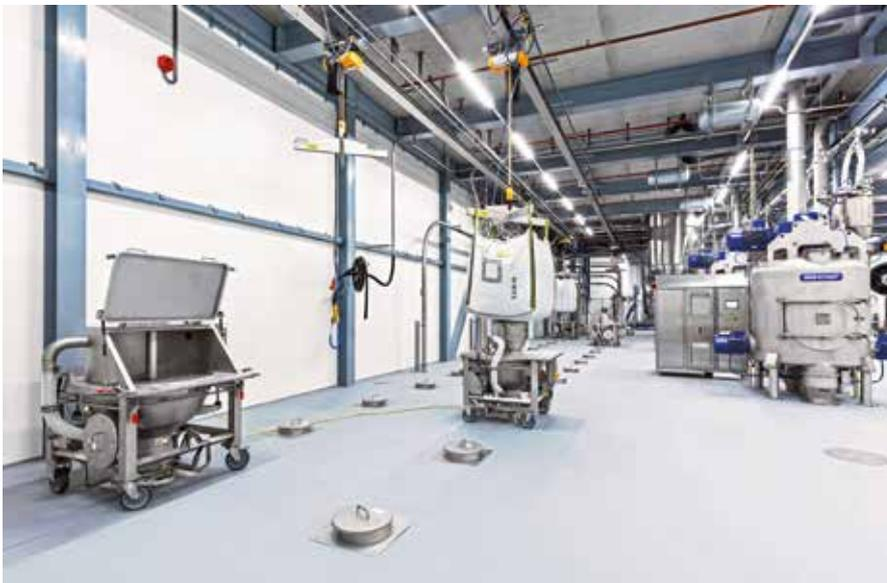
Die Tagessilos werden kontaminationsfrei befüllt, auch die Vertikalmischer wurden nach Hygienic-Design-Vorgaben konstruiert.
