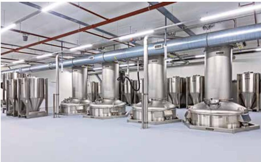
Die Behälterwaagen eignen sich für Volumina von bis zu 10.000 Litern und befinden sich direkt über den Mischlinien.
