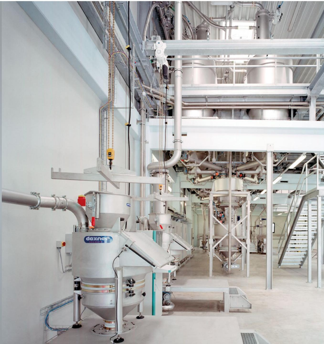
Aufbereitungsanlage für die Produktion von Streichmasse in der Waffel-Erzeugung. Sauberes Handling der hochwertigen Rohstoffe aus Säcken oder Big-Bags. Flüssigkomponentendosierung mit Dosierpumpen durch beheizte Doppelmantelheizungen. Anlagen- und Dosiersteuerung mit lückenloser Rohstoff- und Chargen-Rückverfolgbarkeit.
