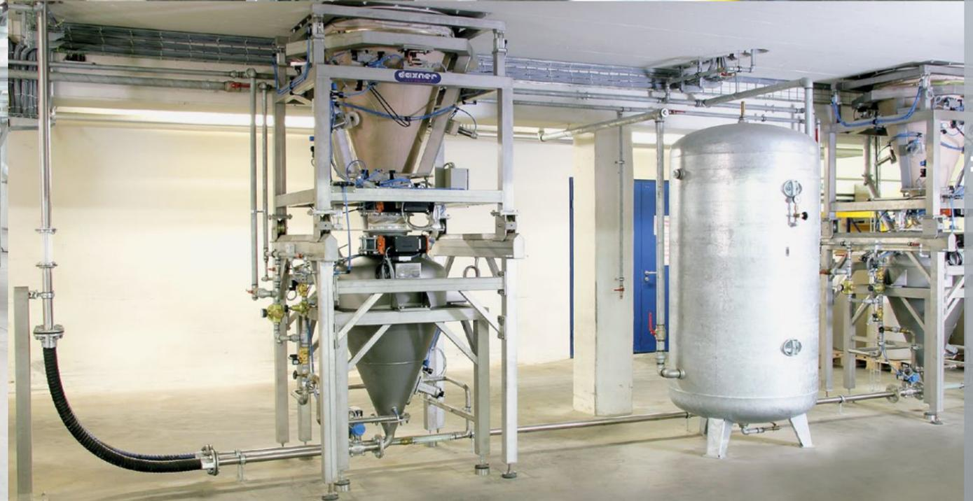
Automatisches Kleinkomponenten Container-Dosiersystem für Mineral- und Wirkstoffmischungen. Das Handling von Komponenten mit schwierigsten Fließigenschaften stellt höchste Anforderungen an das System. Flexiwaage und Dichtstromförderung sind Schlüsselkomponenten hierfür.
