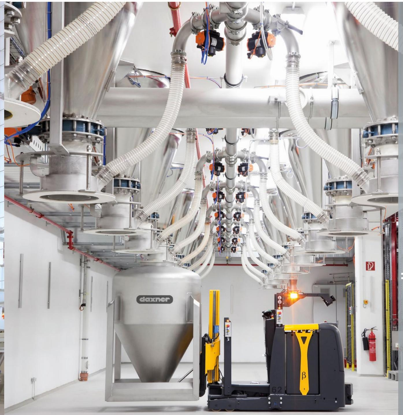
Gefragt sind absolut reine Produktionsanlagen mit höchster Genauigkeit. Vollautomatisches Absammelsystem mittels Daxner Container Systems DCS, FTS (Fahrerloses Transportsystem) für den Containertransport und IBC (Intermediate Bulk Container) in Hygienic Design.
