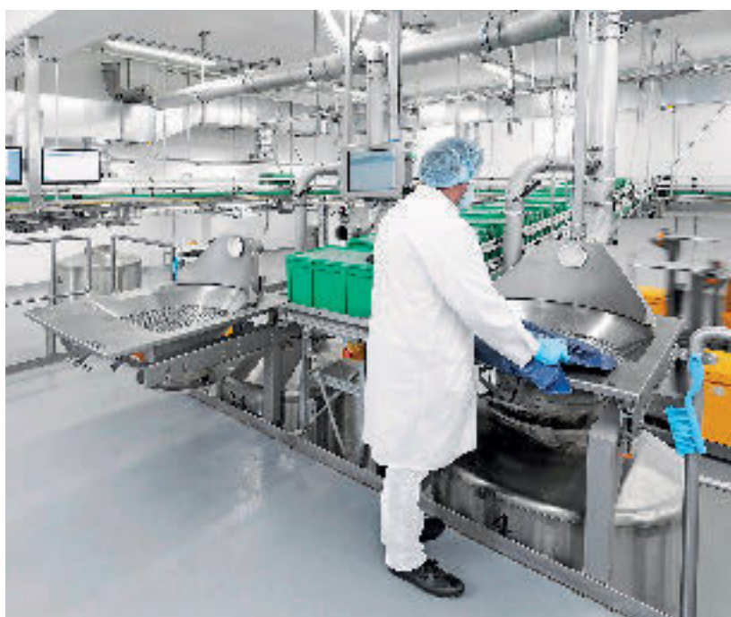
Nach dem Einsammeln der automatisch dosierten Komponenten wird der Container unter Handaufgabestationen positioniert
