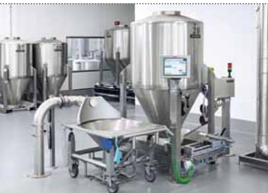
Container-Entleersystem mit automatischem Klappenöffner; Mobile Sackaufgabestation.
