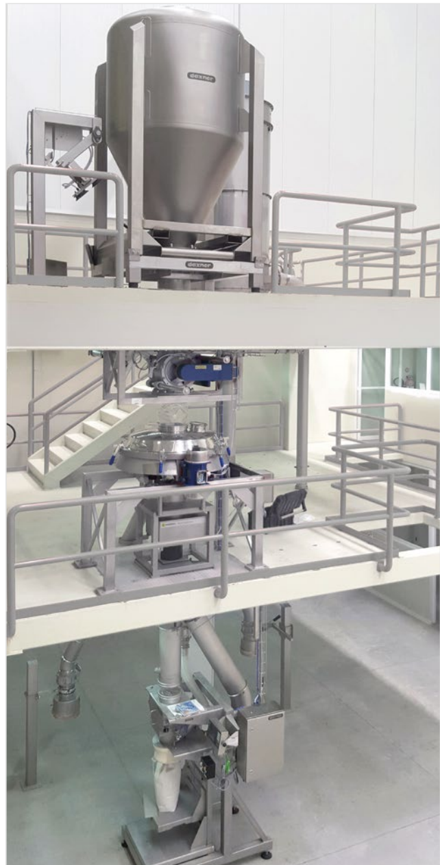
Gesamtansicht der Mischlinie: Kontrollsiebmaschine, Vib&Press, Big-Bag Aufgabestation, Mischer, IBC Andockstation sowie IBC Container
