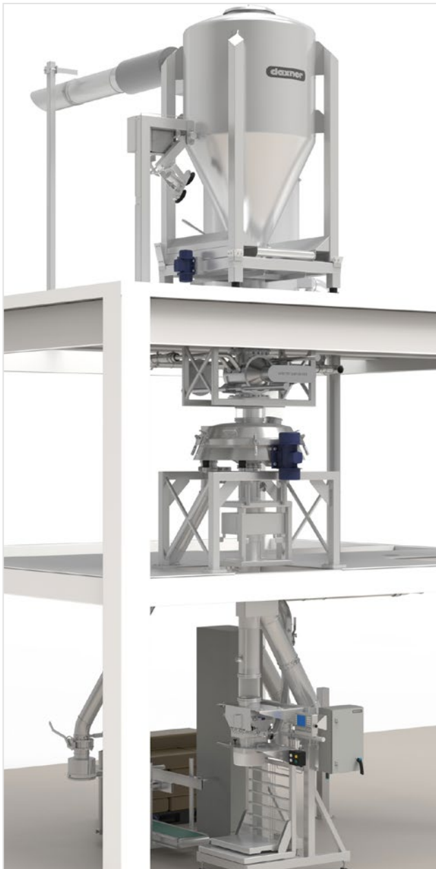
Gesamtansicht der Mischlinie: Kontrollsiebmaschine, Vib&Press, Big-Bag Aufgabestation, Mischer, IBC Andockstation sowie IBC Container
