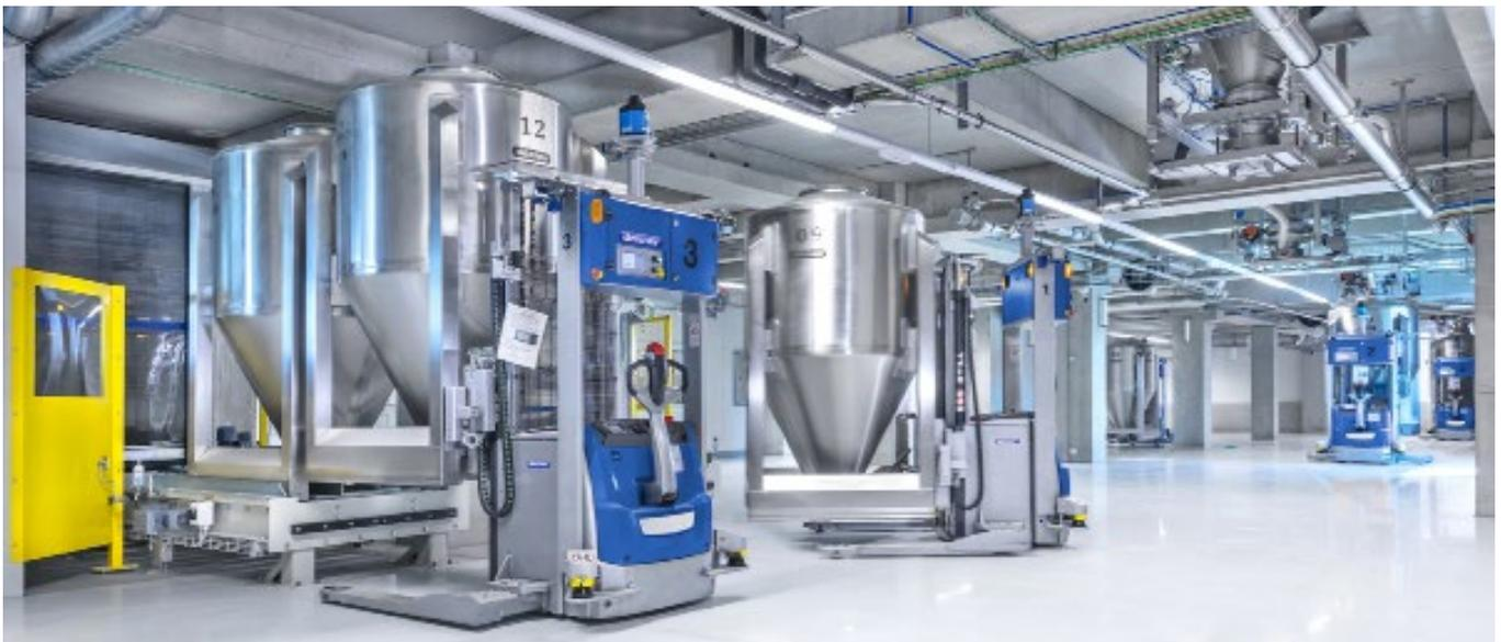
Die Container werden mittels fahrerlosem Transportsystem durch die Anlage bewegt.
