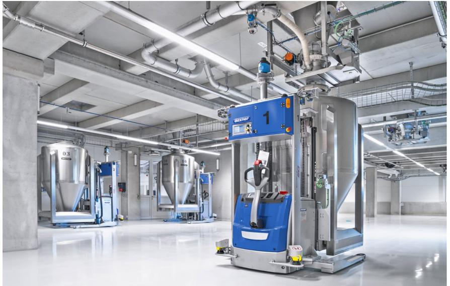
Die dosierten Rohstoffe werden mittels Container und fahrerlosen Transportfahrzeugen (FTS) bei den Waagen und den Handaufgabestationen abgesammelt.
