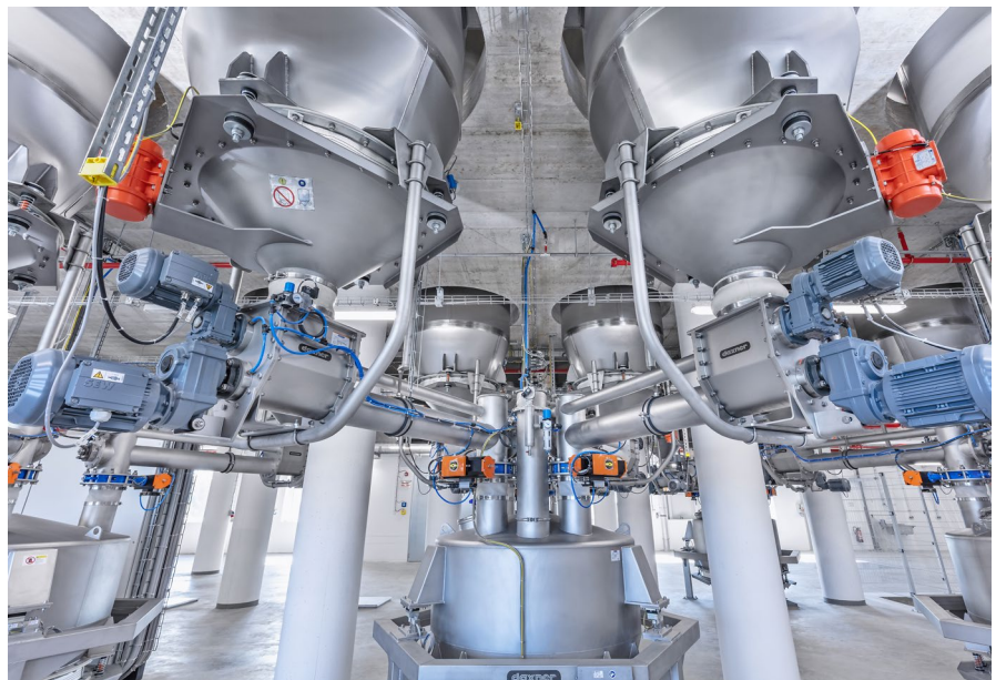
Dosierschnecken zum exakten Dosieren in die Behälterwaage
