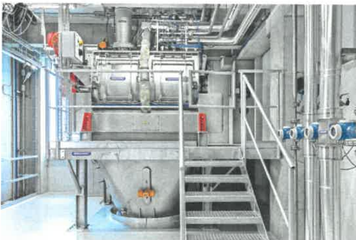
Abb. 6: Mischer mit Nachbehälter und Flüssigdosierung
