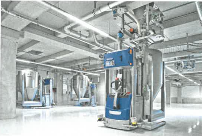
Abb. 4: Die dosierten Rohstoffe werden von fahrerlosen Transportfahrzeugen (FTS) über ein geschlossenes Containersystem an den Waagen und Handaufgabestationen abgesammelt.
