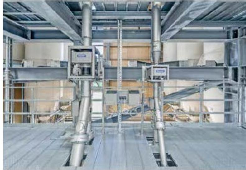
Metalldetektoren für sichere Endprodukte
